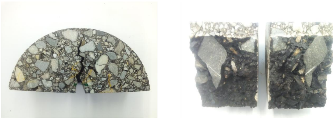
Abbildung 19: Kornbrechender Riss bei einer Prüftemperatur von + 15 °C (Quelle IMP)
