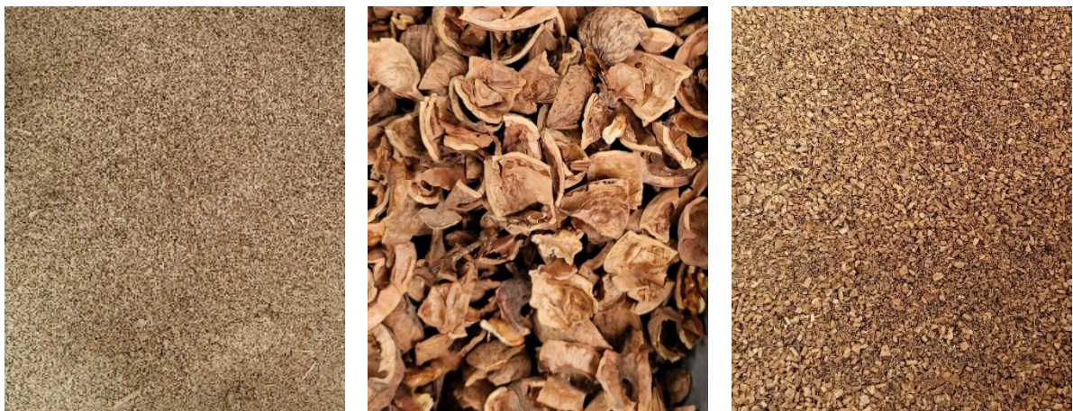
Figure 5 : matières testées, résidus de pellets - coques de noix brutes - coques de noix broyées à 5 mm
