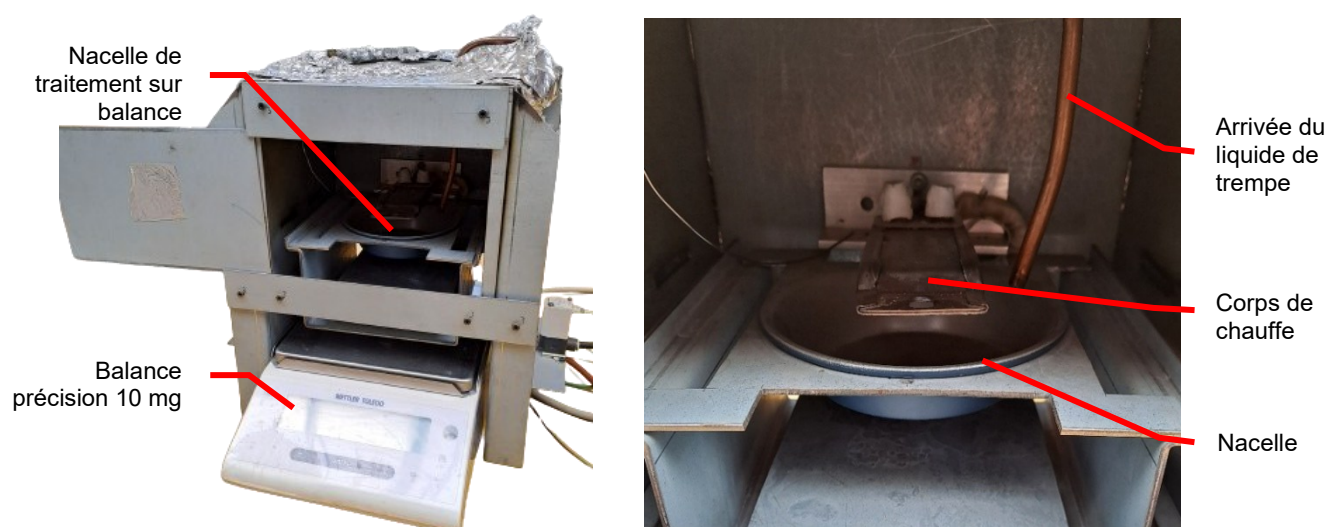
Figure 1 : thermobalance de laboratoire développée pour la torréfaction de la biomasse
