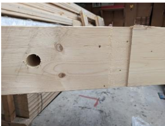
Abbildung 9: Bearbeiteter Balken, die anfallenden Reststücke davon enthalten in diesem Beispiel keinen Leim
