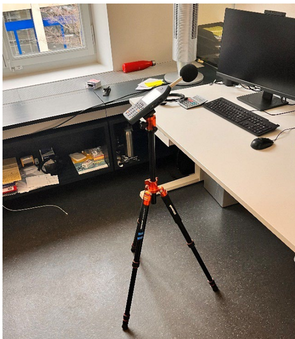
Abb. 2: Schallmessung am Arbeitsplatz Fenster geschlossen.
