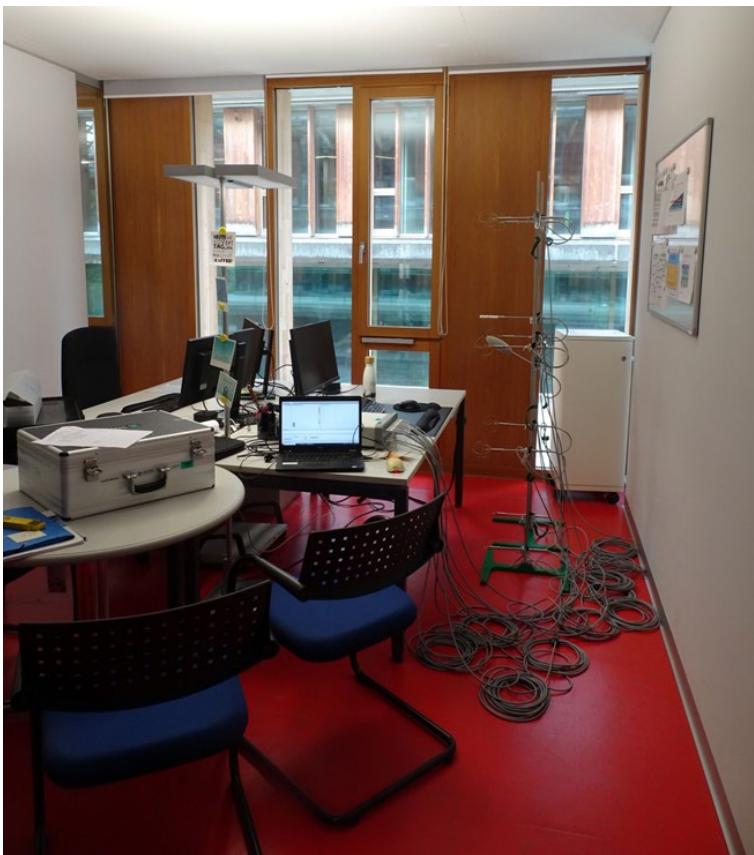
Abb. 108: NL_man_I1_1; Messaufbau Kurzzeitmessung.
