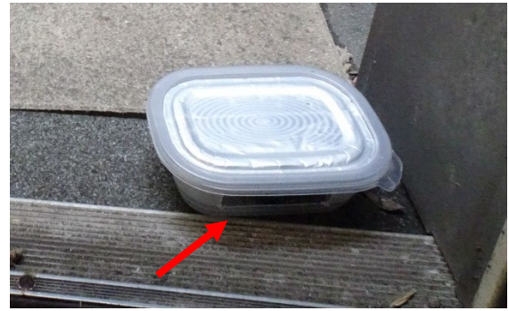
Abb. 5: Lufttemperatur- und Luftfeuchte- Logger mit Schutzgehäuse. Der Pfeil zeigt die Lüftungsschlitze. Der Standort ist möglichst verschattet.
