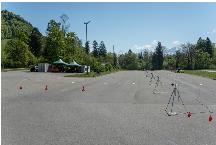
Abbildung 1: Foto der im Jahr 2024 durchgeführten Messkampagne in Stockental mit der mit Pylonen abgegrenzten Messstrecke und rechts der seitlichen Mikrofonlinie entlang der Strecke in 7.5 m Abstand zur Fahrspurmitte.
