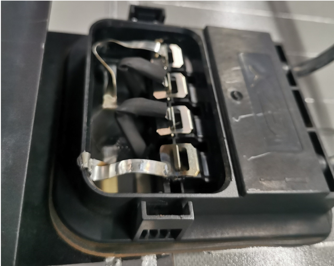
Abbildung 28 Anschlussdose mit über Dosenrand gebogenem Anschlussleiter
