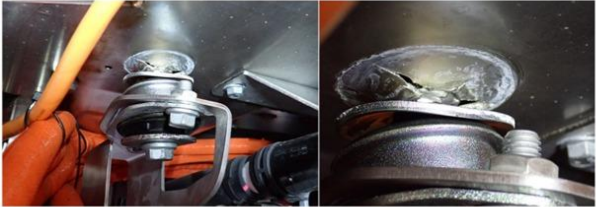
Abbildung 12 Bruch der Aufhängung des Frontmotors
