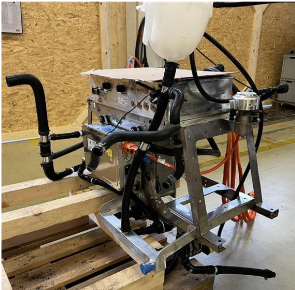
Abbildung 7 Flux 1.0 Geräteträger nach Abschluss der Vormontage
