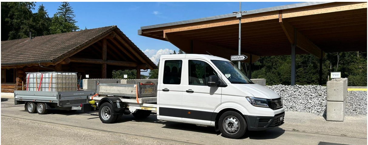
Abbildung 18 AWD-Prototyp mit Anhänger für Leistungstest mit Gesamtzuggewicht
