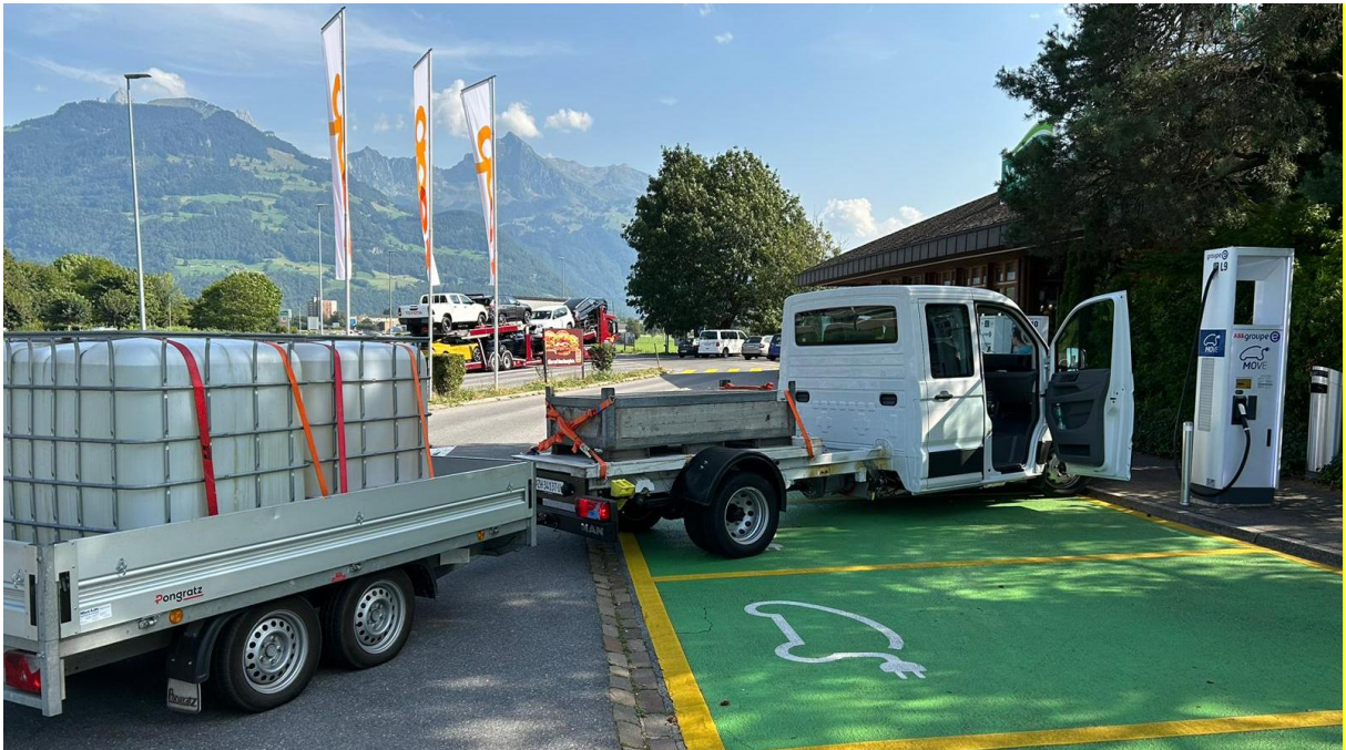
Abbildung 20 AWD-Prototyp mit Anhänger an der Ladesäule während Reichweiten- und Effizienztests
