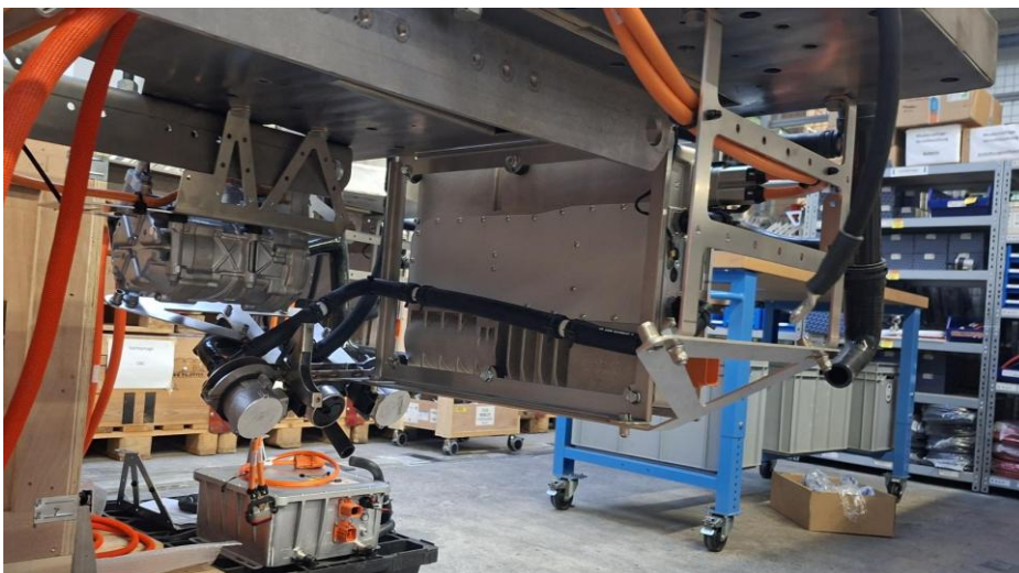
Abbildung 10 Bauraum für den Frontmotor im Geräteträger Flux 2.0 ohne Frontmotor
