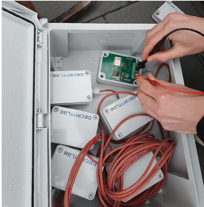
Abbildung 60: Überprüfung der Widerstandswerte der PT1000-Fühler, angeschlossen an den LoRaWAN-Geräten
