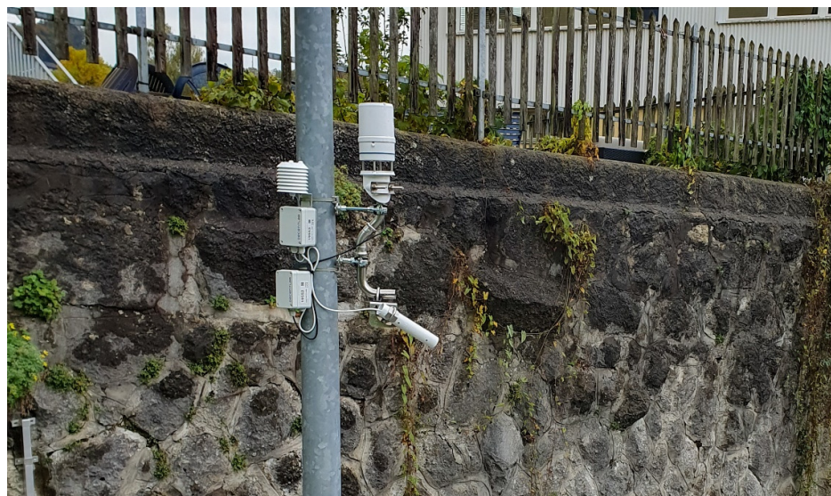
Abbildung 61: Infrarotsensor zur Bestimmung der Oberflächentemperatur des Asphalts und Wetterstation
