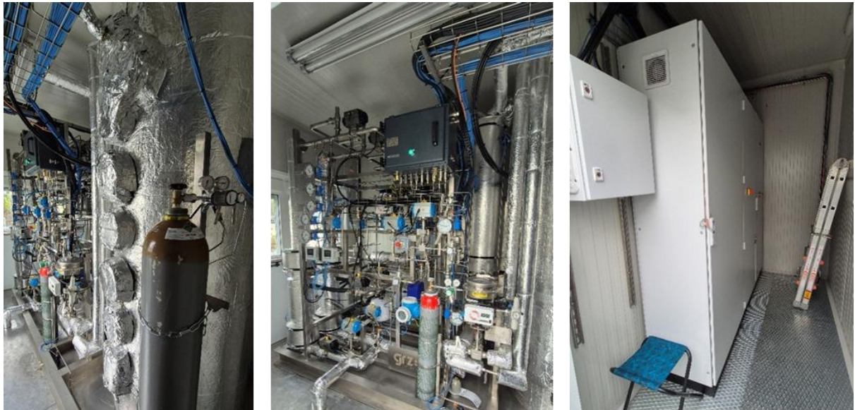
Figure 5 : Photos du réacteur UPSOM (gauche), unités de contrôle process et gaz (au milieu), et armoires électriques de contrôle, site de Gaznat à Aigle
