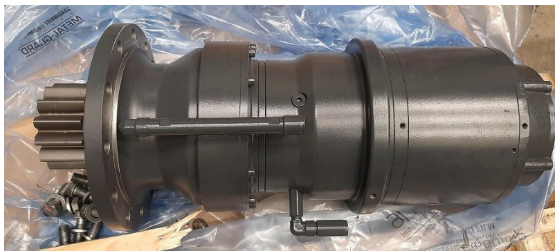
Abbildung 20: Der neue Schwenkantrieb mit kundenspezifischem Ritzel und erhöhtem Übersetzungsverhältnis.
