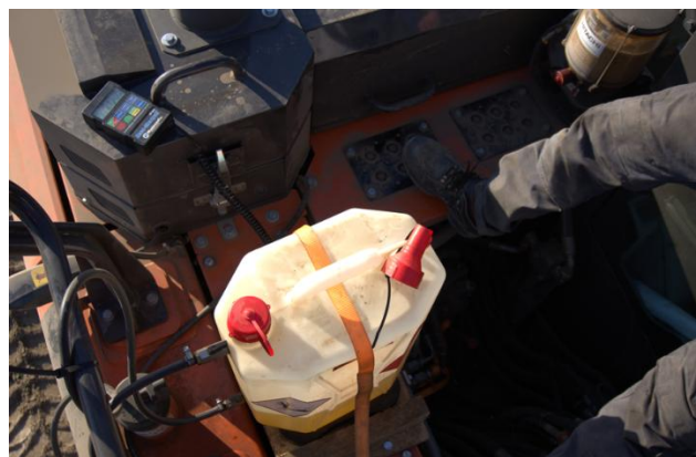
Abbildung 28: Dieseltank mit Paketwage zur Verbrauchsquantifizierung über ein gesamtes Messszenario hinweg.
