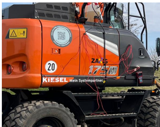
Abbildung 27: Externer Dieseltank auf dem Dach, Messgerät und Sensoren auf Seitenwand und an Verschlauchung.
