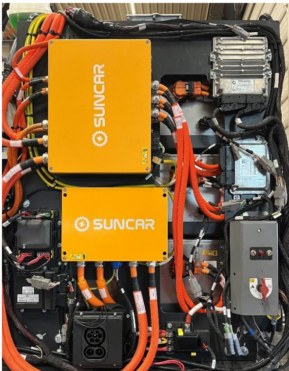
Abbildung 15: Die HVDU FUSION800M (oben) als Herzstück des elektrischen HV-Kreises. Die Aufnahme zeigt nicht den finalen Verkabelungszustand.
