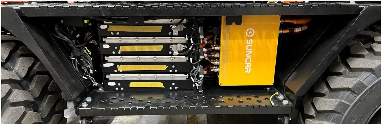
Abbildung 16: Seitenkasten mit Netz-Ladegeräten und HVDU FUSION800M
