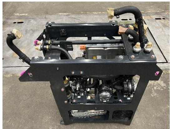
Abbildung 23: Thermoeinheit des ZE150W ohne aufgesetzte Wärmepumpe.
