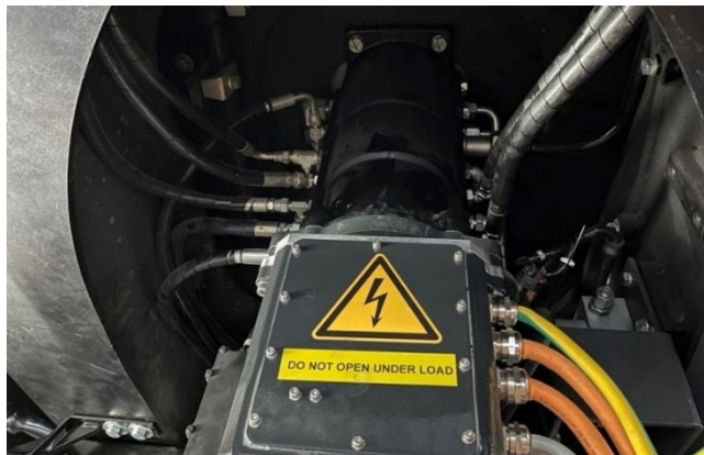
Abbildung 22: Elektrische Drehdurchführung unterhalb der hydraulischen.
