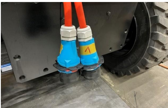
Abbildung 17: Auswurfstecker zur Sicherheit für Schadensprävention
