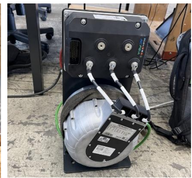
Abbildung 21: Inverter und Motor für die Pilot- und Bremspumpe
