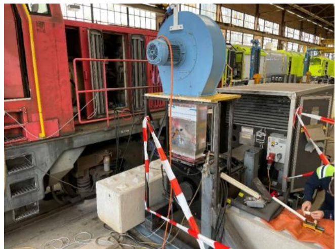
Abbildung 11: Einblick in Prüfung der Fahrmotoren während der Machbarkeitsstudie
