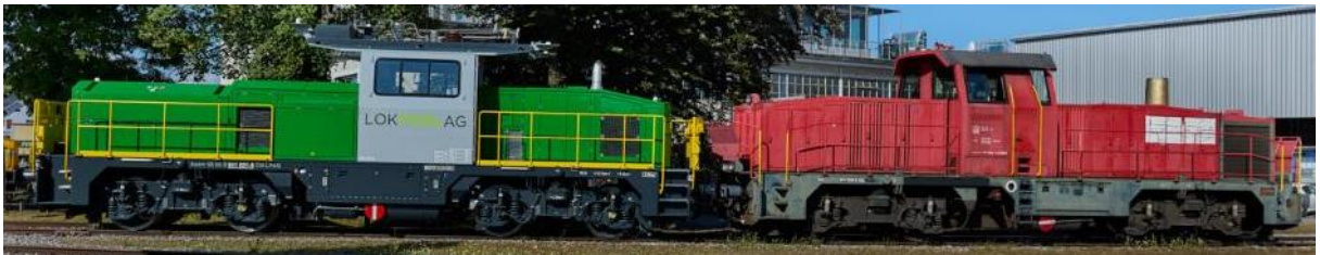
Abbildung 17: Aeam 841 mit Am 841 gekuppelt
