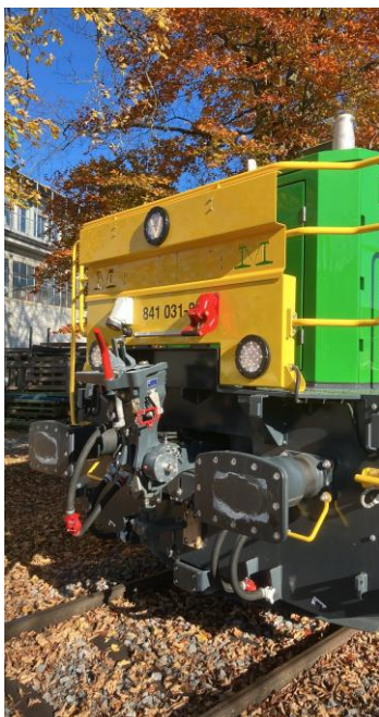
Abbildung 21: Hybridkupplung – Stellung Zughaken / Stellung DAK
