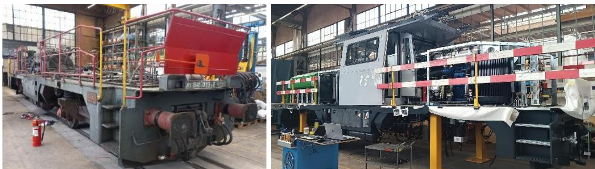
Figure 2 : Am 841 en cours de démantèlement et Aeam 841 en cours de construction.
