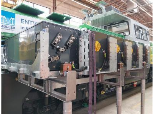
Abbildung 23: Batterieschublade auf Hilfsgerüst an Aeam 841
