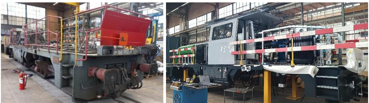
Abbildung 2: Am 841 im Rückbau und Aeam 841 im Aufbau
