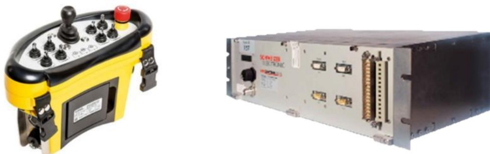
Abbildung 14: Sender und Empfänger der Funkfernsteuerung von Schweizer Electronic [1]
