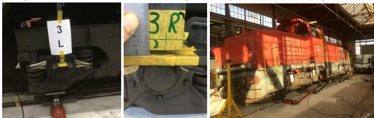
Abbildung 13: Einblick in Prüfung der Wankdaten während Machbarkeitsstudie
