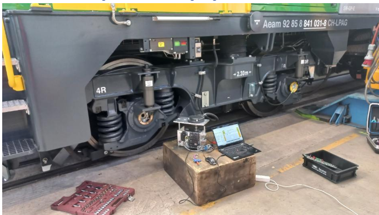
Abbildung 27: Versuchsaufbau – exzentrische Montage Achsgeber
