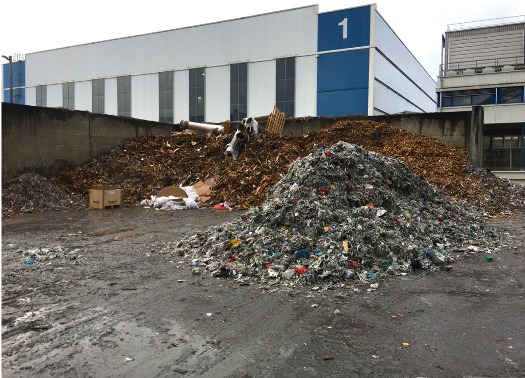
Abbildung 4: Zusatzbrennstoffe Energieholz-Altholz (hinten), Kunststoff-Reject (vorne rechts)
