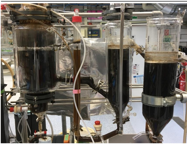
Abbildung 29: Labor-Kläranlage mit Belüftungsstufe, Schlammabscheider, Nachklärung.
