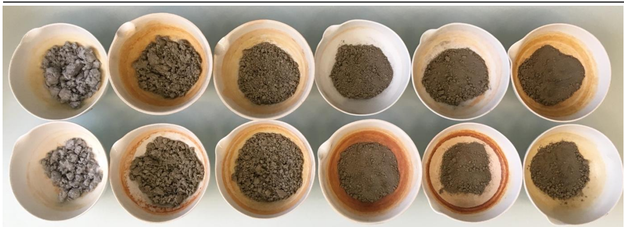
Abbildung 14: Einfluss der Carbonisierungs-Bedingungen auf die Substratstruktur, v.l.n.r. entwässerter Papierschlamm, gemahlene Biokohle mit steigender Severity 5.4, 5.4, 5.7, 5.8, 5.9
