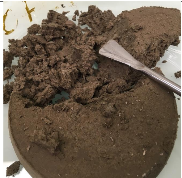
Abbildung 12: Absetzverhalten von Slurry aus Papierschlamm, Abbildung 13: Filterkuchen Biokohle aus PPS
