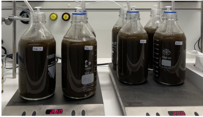
Abbildung 10: AIA-Test, Reaktorflaschen vorbereitet mit Probelösungen und Belebtschlamm (Quelle: eigenes Bild).
