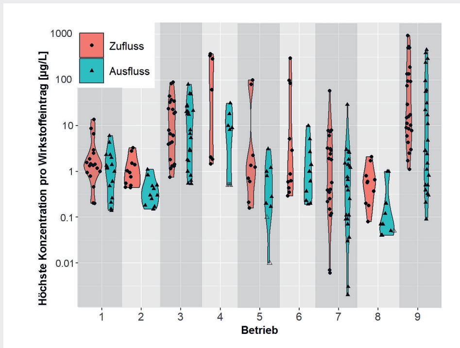
Fig. 4 Höchste gemessene Konzentrationen im Zu- und Ablauf jedes pulsartigen Werkstoffeintrags, verursacht durch die Einleitung von Betriebsabwasser. Nicht gefüllte Symbole zeigen die Bestimmungsgrenze für Substanzen mit Pulseintrag, die im Auslauf nicht mehr zuverlässig quantifiziert werden konnten.
