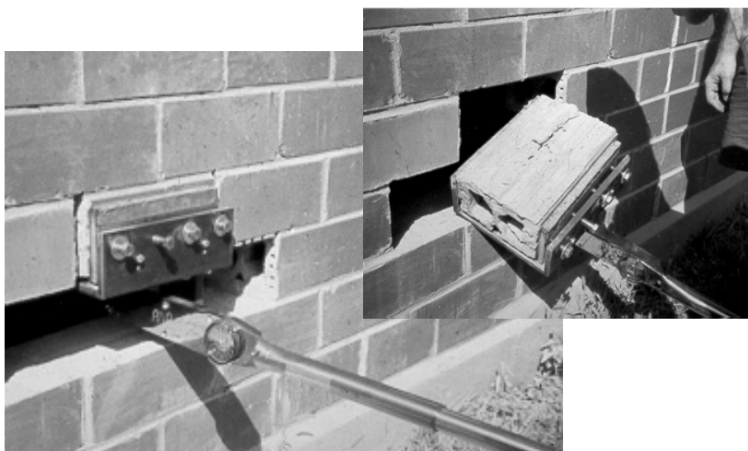
Abbildung 13: Bond-Wrench-Test zur Ermittlung der Haftscherfestigkeit gemäss SN EN 1052-5 [31].
