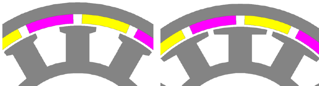
Figure 40 : Vue de l'élargissement des épanouissements des dents au stator (18° à gauche, 27° à droite)
