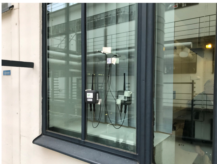
Mesure de la valeur U du vitrage des fenêtres d'un bâtiment de l'entreprise pharmaceutique Roche à Bâle, examiné dans le cadre du projet FenSanReuse. Photo : INEB
