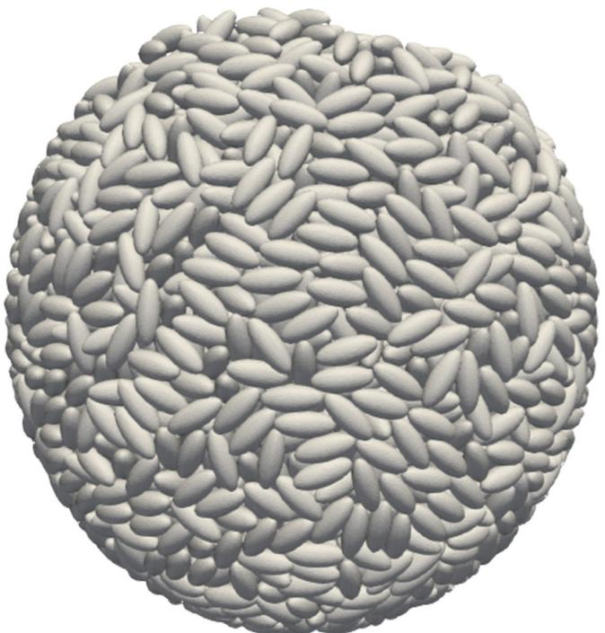
Die Visualisierung veranschaulicht zwei mögliche Speichergeometrien. Darin sind die aus dem Kunststoff Polyethylen gefertigten und mit Phasenwechselmaterialien gefüllten Kapseln zu erkennen. Illustration: Schlussbericht HyTES
