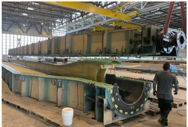
Abbildung 38: Verkleben beider Blatthälften
