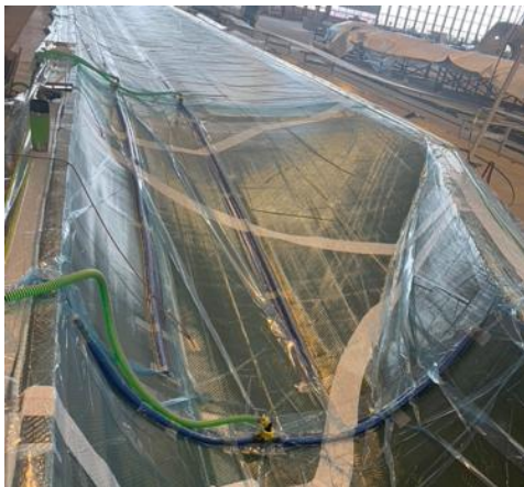
Abbildung 37: Infusion einer Blatthälfte
