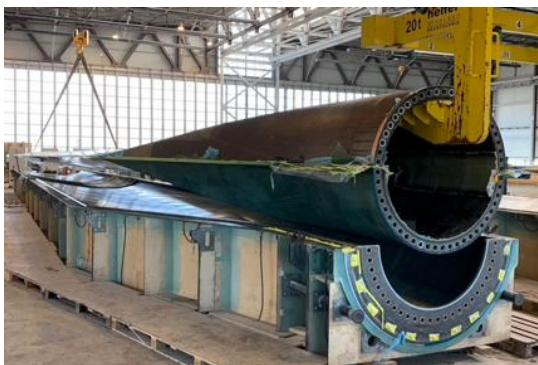
Abbildung 39: Entformen des verklebten Blattes
