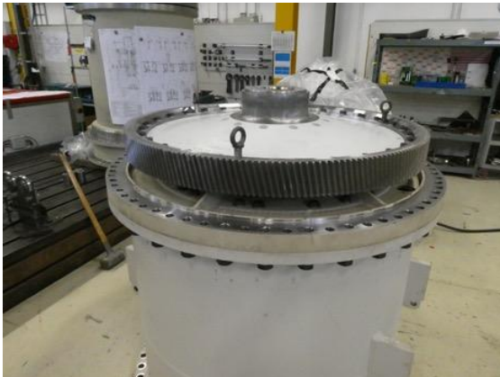
Abbildung 23: Aufschrupfen des Stirnrads
