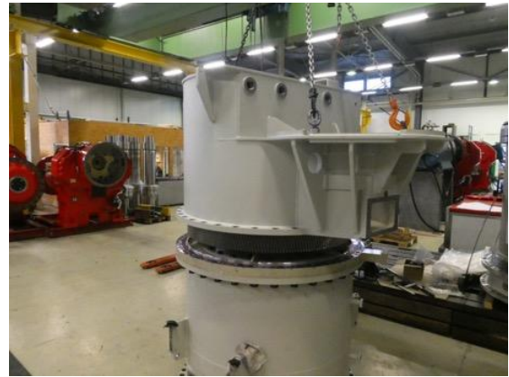
Abbildung 24: Zusammenfügen von Abtriebsgehäuse an Planetenstufe
