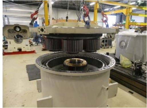
Abbildung 22: Einfügen des Planetenträgers in das Gehäuse
