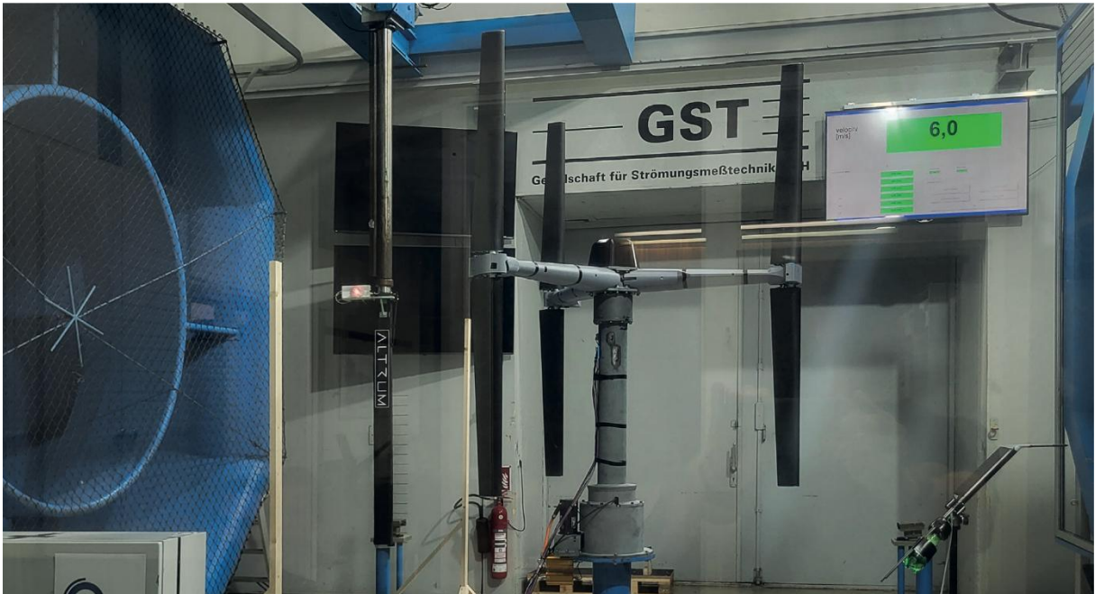
Abbildung 9: Versuchsreihen im Windkanal mit einem kleinen voll funktionsfähigen Vertical Sky®-Modell
