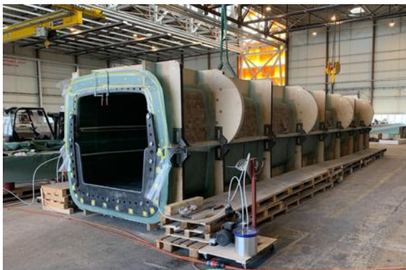
Abbildung 47: Verkleben der beiden Hälften
