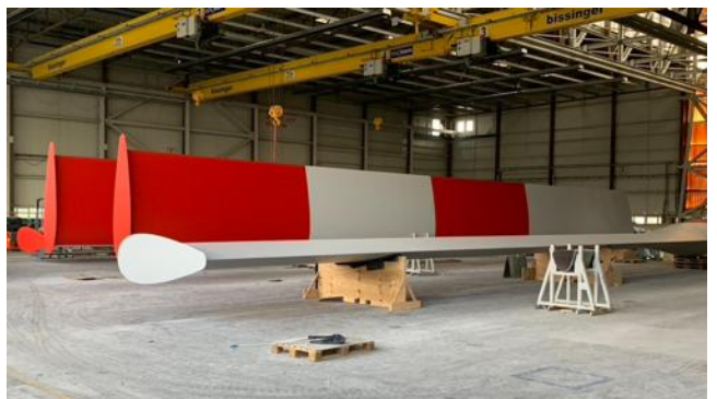
Abbildung 40: fertige Rotorblätter, bereit für den Transport
