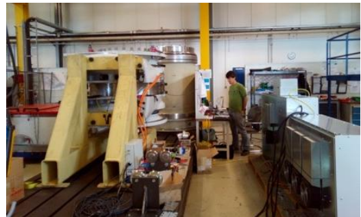
Abbildung 17: Teilinbetriebnahme Pitchantrieb im Werk
