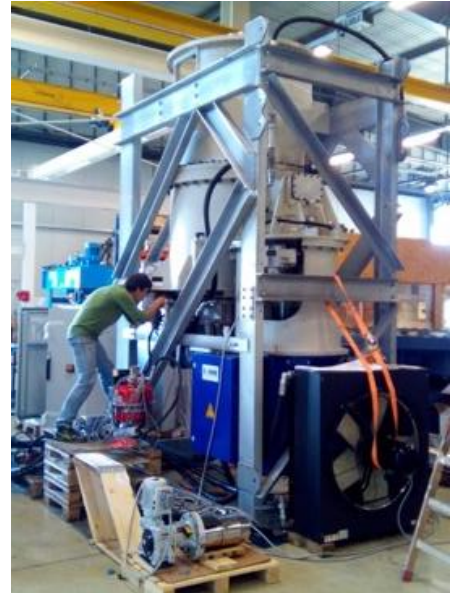
Abbildung 16: Teilinbetriebnahme Getriebe im Werk
