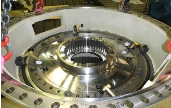
Abbildung 21: Messen / Einstellen des LSS Lagerspiels (Low Speed Shaft)
