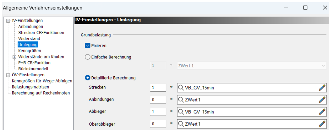
Abbildung 13: Integration des Strassengüterverkehrs als Vorbelastung über ein Strecken-BDA
