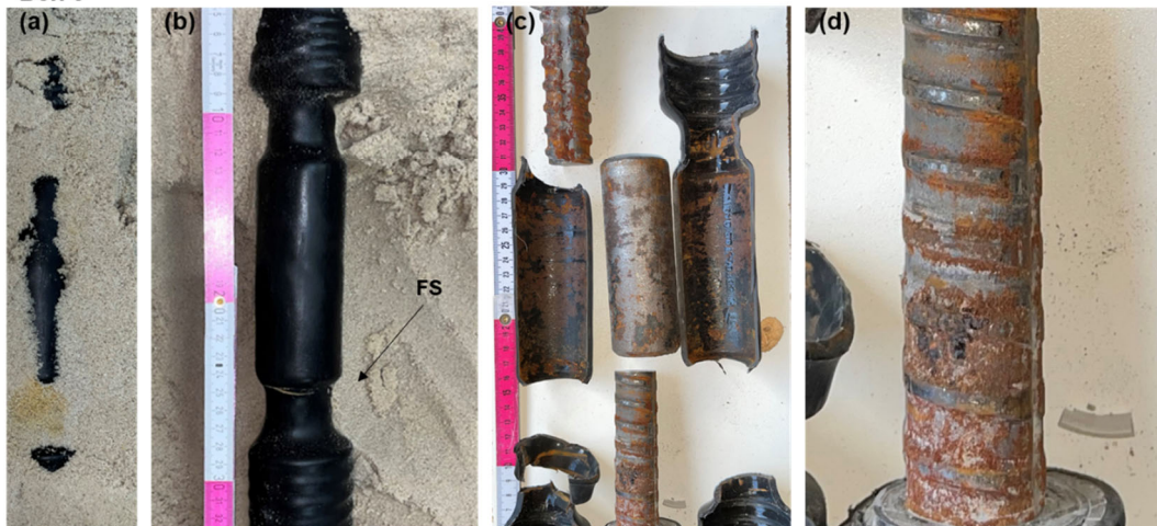
Abb. 53 Kupplung mit Fehlstelle (FS) (a) auf Höhe Pfahloberfläche (b) freigelegter Pfahl (c) ausgebaute Kupplung (d) ausgeschraubte Bewehrung oben: aus Box 1 mittig: Box 2 und unten: aus Box 3
