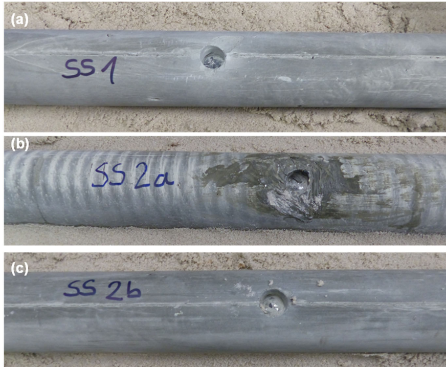
Abb. 35 Künstliche Fehlstellen in Mikropfählen (a) SS1, (b) SS2a (Hüllrohr entfernt) und (c) SS2b.
