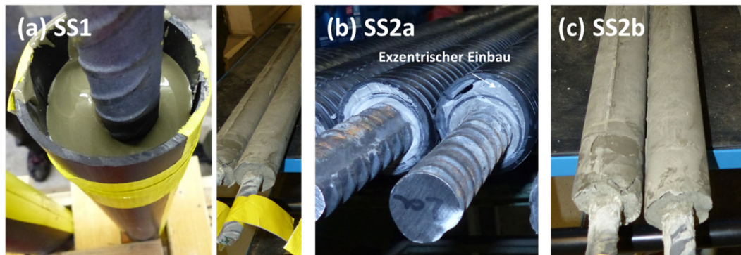
Abb. 33 (a) Herstellung Schutzstufe 1 (SS1), (b) Schutzstufe 2 (SS2a) mit Kunststoffhüllrohr und exzentrische Lage des Stahltragglieds, (c) Proben der Schutzstufe SS2b (nicht-rostender Stahl) hergestellt mit Bewehrungsstäben der Korrosionswiderstandsklasse KWK 1 [15].
