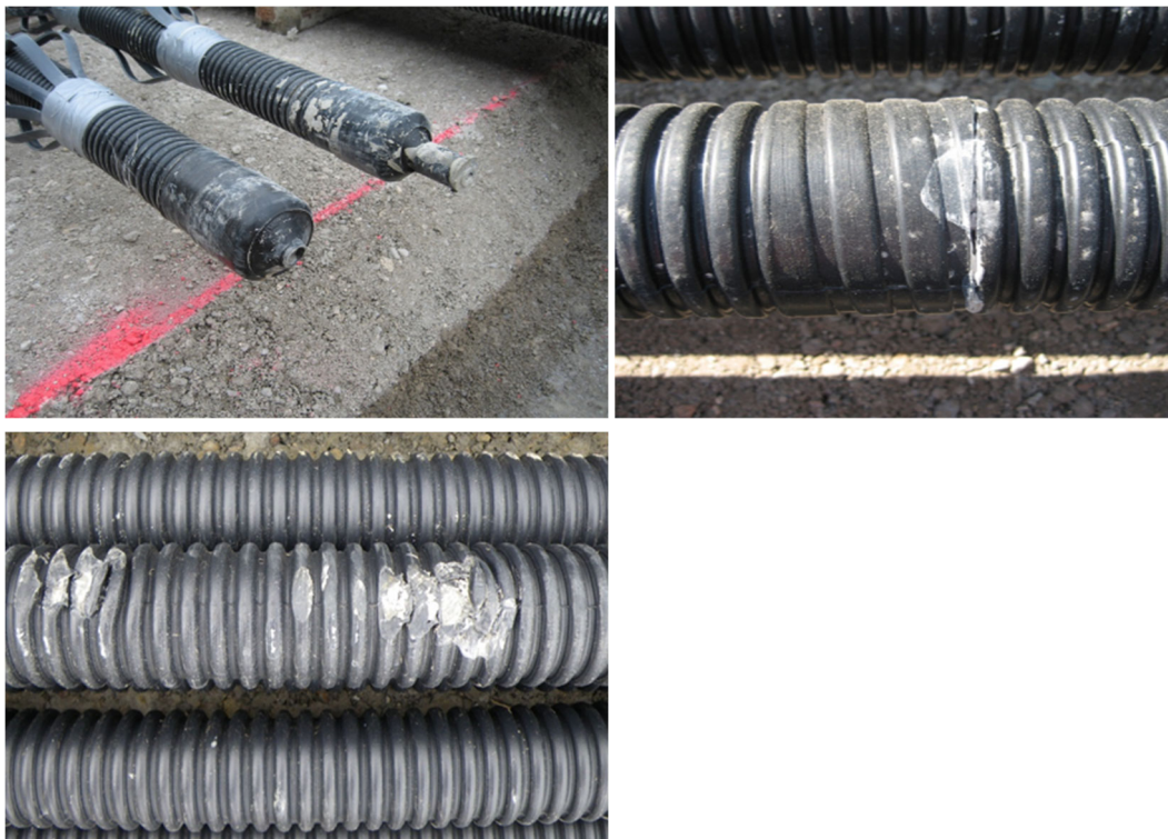
Abb. 6 Ausgrabung /Mängel an Kunststoffhüllrohren: Oben links: Abgescherter Injektionsstutzen. Oben rechts: Undichter Hüllrohrstoss. Unten rechts: Defektstellen infolge mechanischer Einwirkungen (Fotos: Y. Schiegg).
