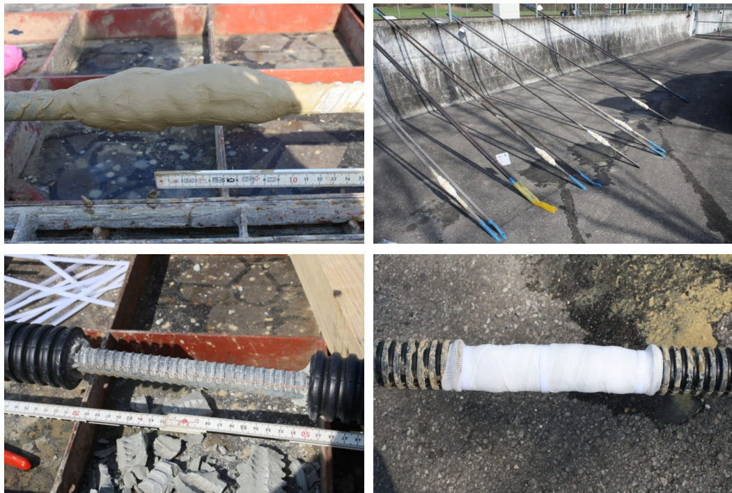
Abb. 15 Feldversuch mit Mikropfählen, Vorbereitung der Stahltragglieder.
