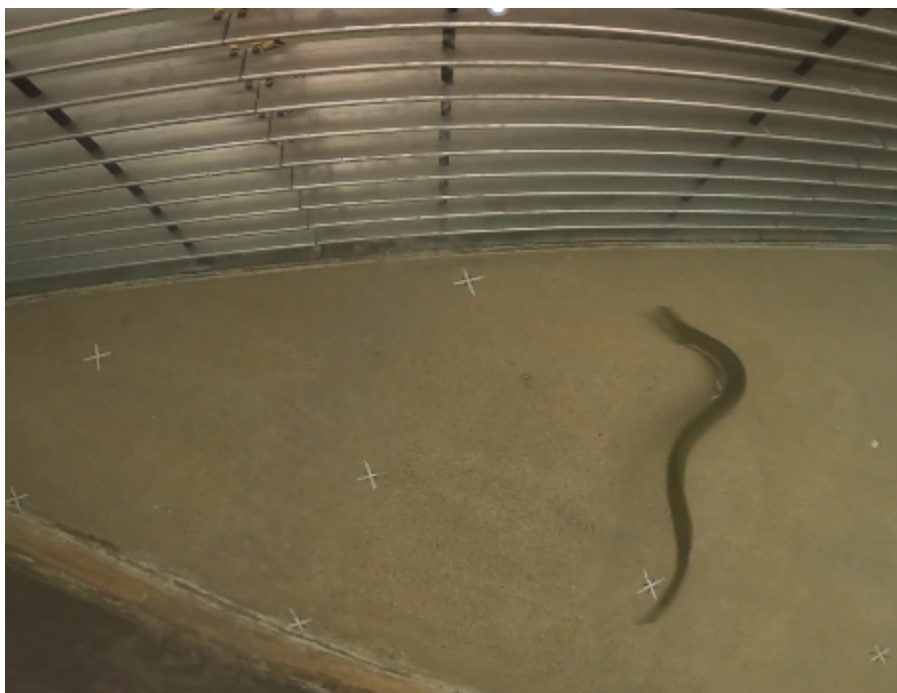
Abbildung 7: Standbild aus Unterwasser-Videoaufnahme: Versuch mit Horizontalrechen, ein Aal nähert sich dem elektrifizierten Rechen; Fließrichtung von rechts nach links.
