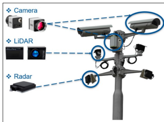
Abbildung 16: Eine Illustration des Sensoreinsatzes am Mast [113].
