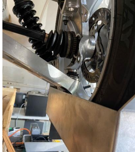
Figure 6-10 Problème de bac pour roue
