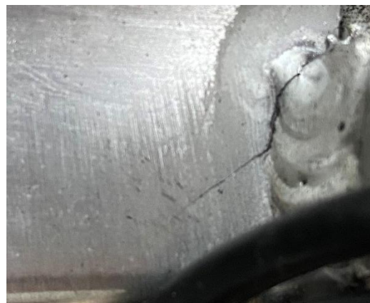
Figure 8-21 Fissure latérale 23 heures
