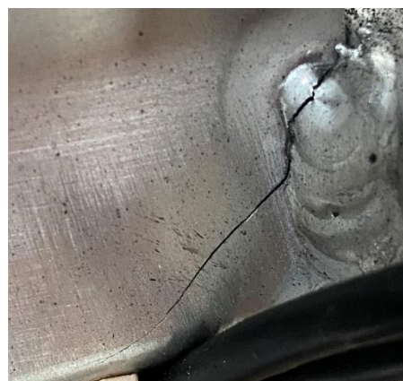
Figure 8-23 Fissure latérale 32 heures
