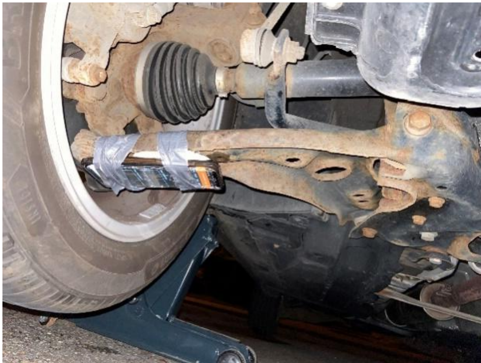
Figure 29 : Installation d'un accéléromètre sur la triangulation de support de suspension d'une roue de Volkswagen Golf pour tester le déplacement vertical du moyeu en condition réel. Source : extrait de Validation expérimentale du châssis d'une voiture électrique , Gaël Monnard, 2024.
