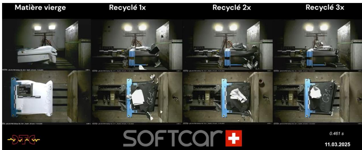
Figure 43 : Photos comparatives des 4 états des pièces rotomoulées après l'impact et leur position. Source : DTC & SOFTCAR, 2025
