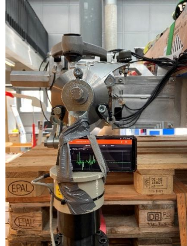
Figure 3-20 Mesure de l'accélération verticale du moyeu sur le banc
