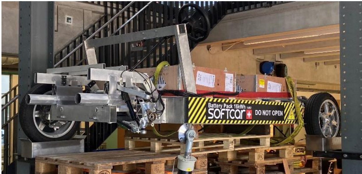
Figure 4-4 Châssis découplé pour instrumentation
