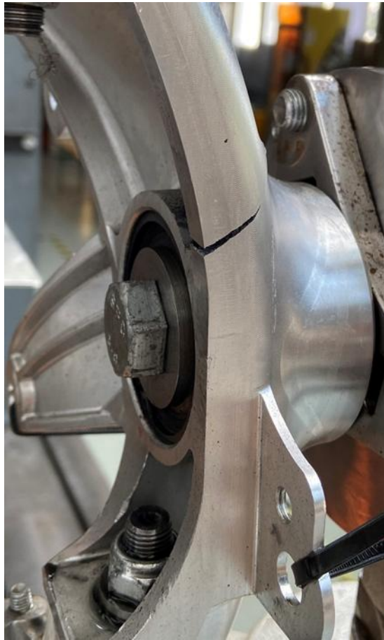
Figure 33 : Fissure du porte-moyeu du berceau avant après 40 heures de test. Source : extrait de Validation expérimentale du châssis d'une voiture électrique , Gaël Monnard, 2024.
