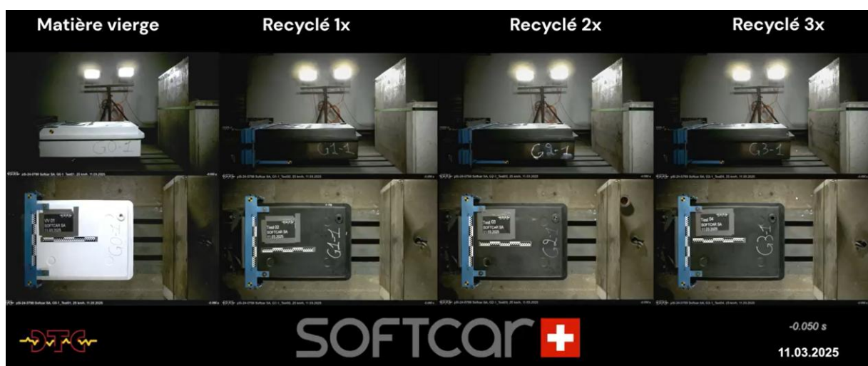
Figure 41 : Photos comparatives des 4 états des pièces rotomoulées avant le lancement du crash. Source : DTC & SOFTCAR, 2025
