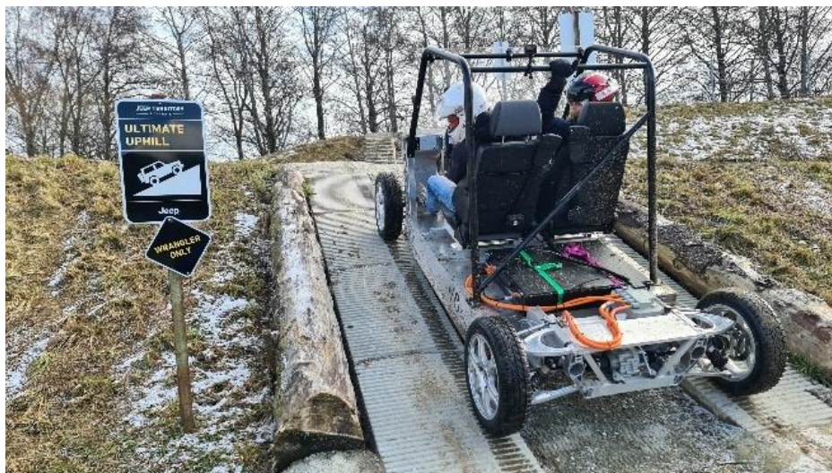
Figure 50 : Test de franchissement du châssis sur les rampes réservées aux 4x4. Source : SOFTCAR, 2021
