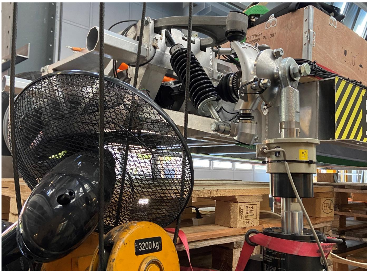
Figure 8-31 Refroidissement par ventilateur de la suspension arrière
