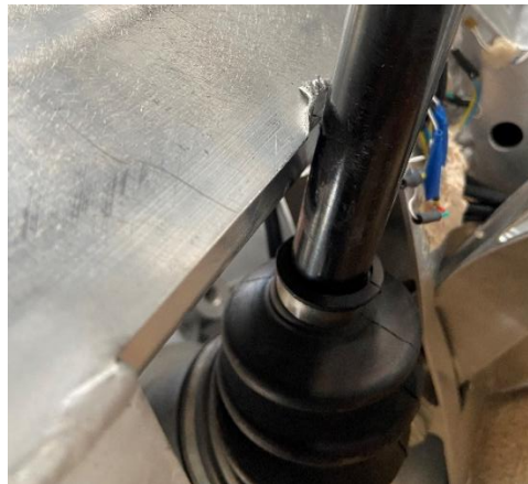
Figure 8-40 Endommagement de la parois au dessus du cardan
