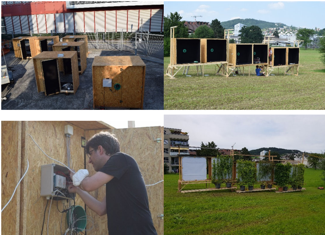
Abbildung 3: Aufbau der Messstationen
