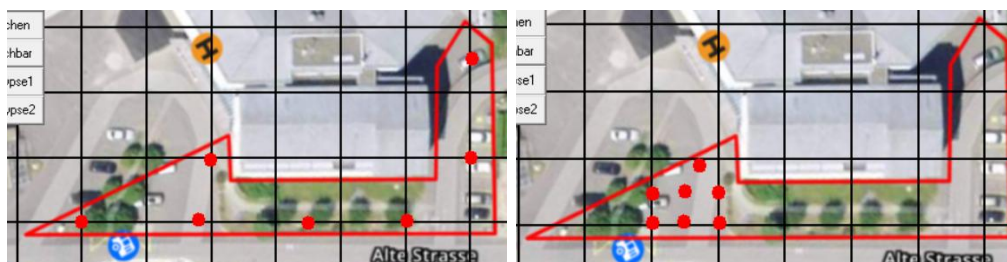
Abbildung 13: Sondenfeld «Verteilt» (links) und «Kompakt» (rechts)
