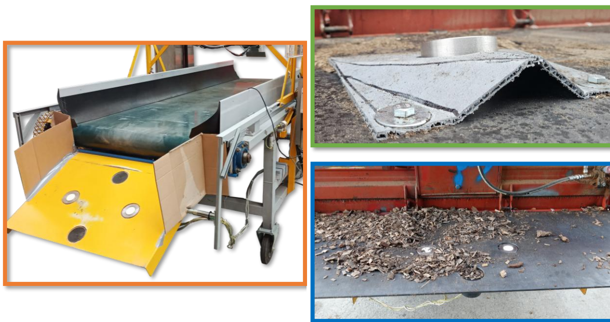
Figure 20 : Représentations des trois configurations de montage du capteur \mu O SWR avec le tapis fixe (orange), le déflecteur de remorque avec capteurs affleurés (bleu) et le déflecteur de remorque avec capteurs surélevées
