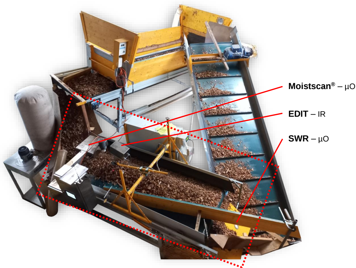
Figure 10 : Dispositif de test des 3 capteurs d'humidité pour la mesure en continu des plaquettes forestières avec, en encadré, le tapis de mesure
