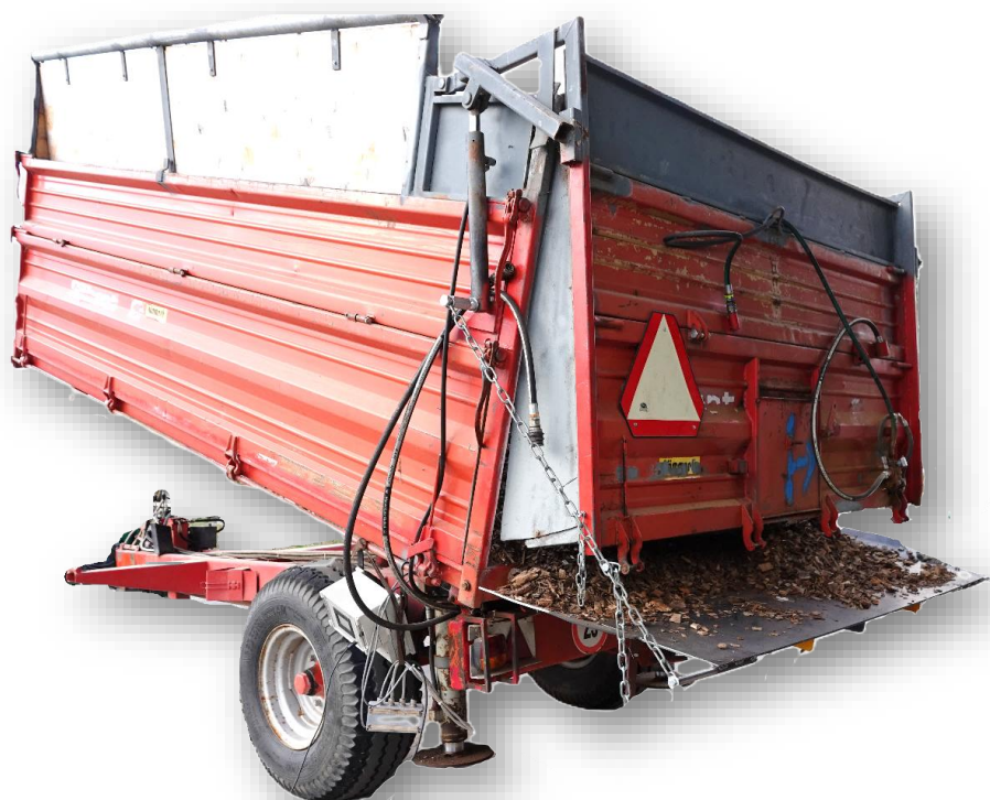
Figure 18 : Remorque à fond basculant équipé d'un déflecteur avec les capteurs \mu O SWR
