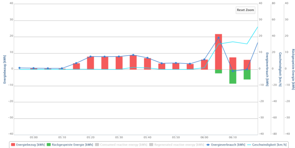
Abbildung 5. Saisonale Vorbereitung des GTW 009 am 18.11.2024. Die Vorbereitungsdauer startet um 5:15 Uhr, planmässige Abfahrt ist 6:00 Uhr. Die saisonale Vorbereitungsdauer beträgt 45 Minuten im November. Das Fahrzeug wird gegen 5:30 Uhr rangiert (hellblaue Linie steigt leicht an). Entsprechend steigt der Stromverbrauch in dieser Zeit ebenfalls leicht an. Zeitintervall der Verbrauchsdaten ist 5 Minuten.
