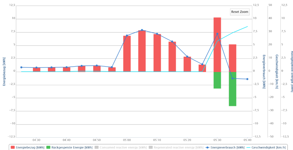
Abbildung 2: Saisonale Vorbereitung der GTW 004, Abstellung am 22.08.2024 in Beinwil am See. Vorbereitungs- dauer von 5:00 - 5:30 Uhr, also 30 Minuten. Zum Vorbereitungszeitpunkt um 5:00 Uhr steigt der Energieverbrauch markant an. Planmässige Abfahrtszeit ist 5:28 Uhr, erkennbar am deutlichen Anstieg der Geschwindigkeit. Der Zeitintervall der Verbrauchsdaten ist 5 Minuten.
