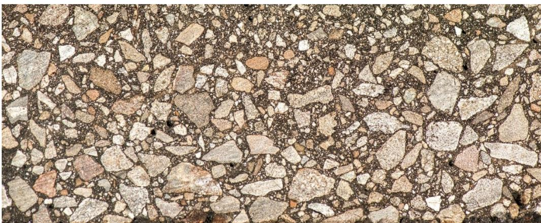
**Abb. 44** Querschnitt eines Probekörpers für die Eindringtiefe nach SN EN 12697-25 Prüfverfahren A2, der beim Abkühlprozess der Herstellung vibriert wurde. Klar ersichtlich ist die oberflächennahe Entmischung.
