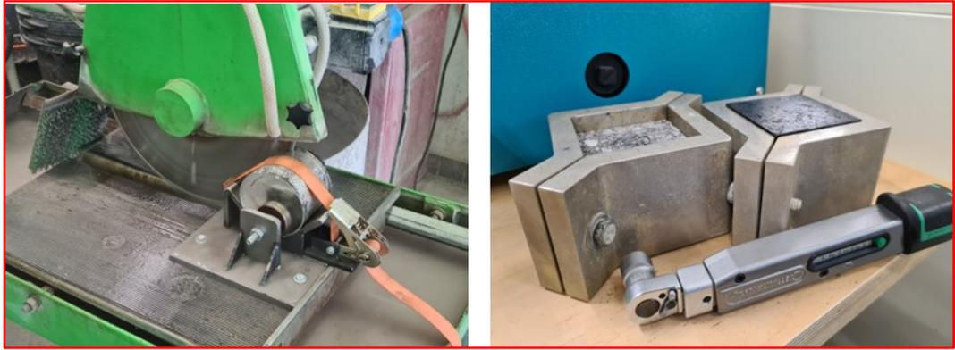
**Abb. 52** Schneidhilfe für Würfel und Zylinder; Schraubenanzug mit Drehmomentschlüssel.
