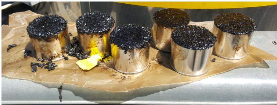
**Abb. 23** oben: Prüfkörper auf ebener und stabiler Unterlage. unten: Prüfkörper auf vibrierender Unterlage (auf dem Kotflügel des MA-Kochers mit laufendem Rührwerk).
