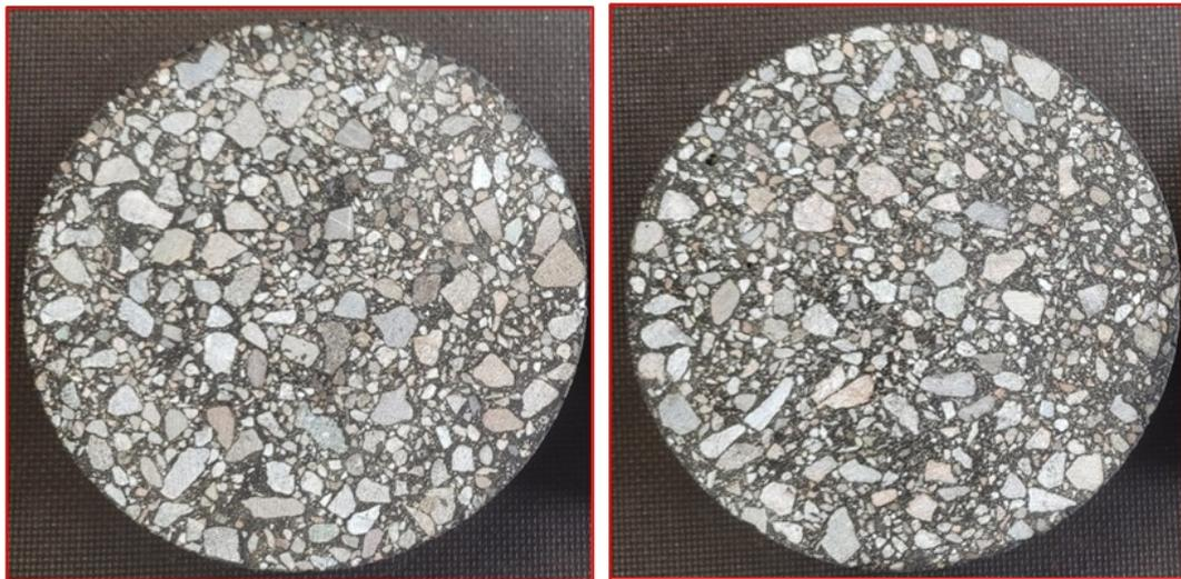
**Abb. 47** Probekörper 2 Fläche unten (links) und Fläche oben (rechts) zeigen keine offensichtliche Entmischung.
