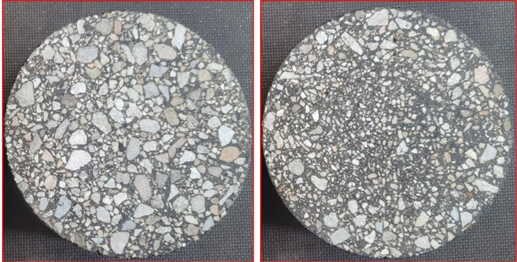
**Abb. 48** Probekörper 1 zeigt schon an den geschliffenen Flächen eine klare Entmischung. Linke Seite: Fläche unten, rechte Seite: Fläche oben.
