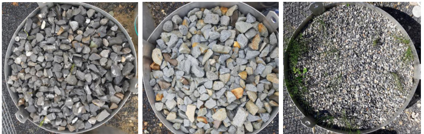
Abbildung 6: Lysimeter Lanzenhäusern (links) und Nottwil (Mitte) mit Schotterauflage, Lysimeter Wabern (rechts) mit Kiesauflage
