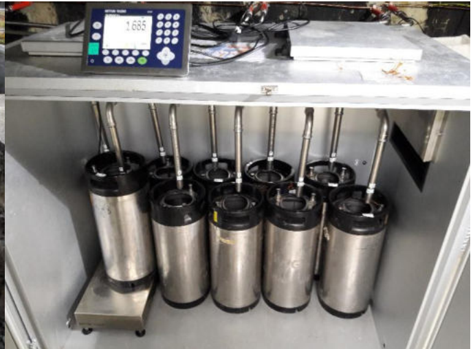
Abbildung 3: Sickerwasser-Auffangbehälter in Kühleinheit mit einem Behälter auf einer Waage
