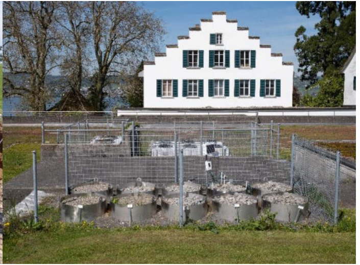
Abbildung 5: Eisenbahn-Lysimeter befüllt mit Erdmaterial von den Standorten Wabern (links), Nottwil (Mitte) und Lanzenhäusern (rechts)
