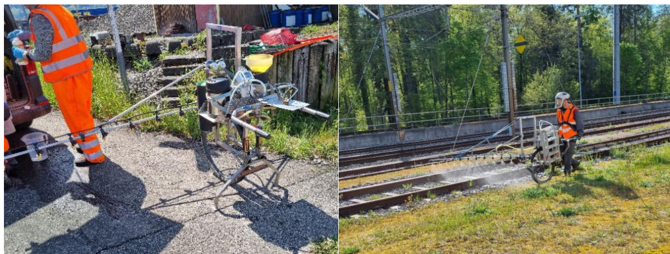
Abbildung 21: 2021 verwendete Parzellenspritze (links) und Herbizidapplikation am Standort Bülach (rechts)
