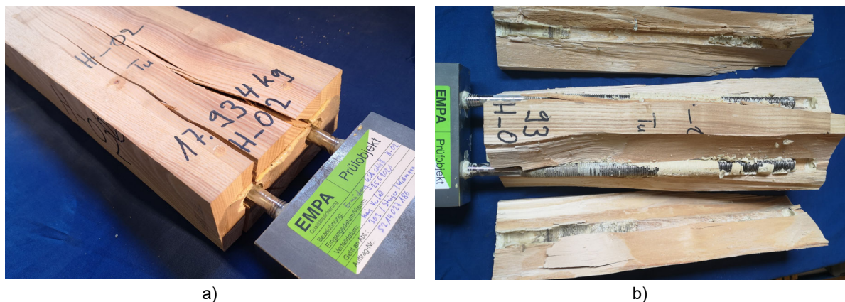
Abb. 4.8: Versagensbilder in der Versuchsreihe A1: a) Prüfkörper A1-02 nach dem Ausziehversuch, b) Unterer Anschluss des Prüfkörpers A1-02 zerlegt.
