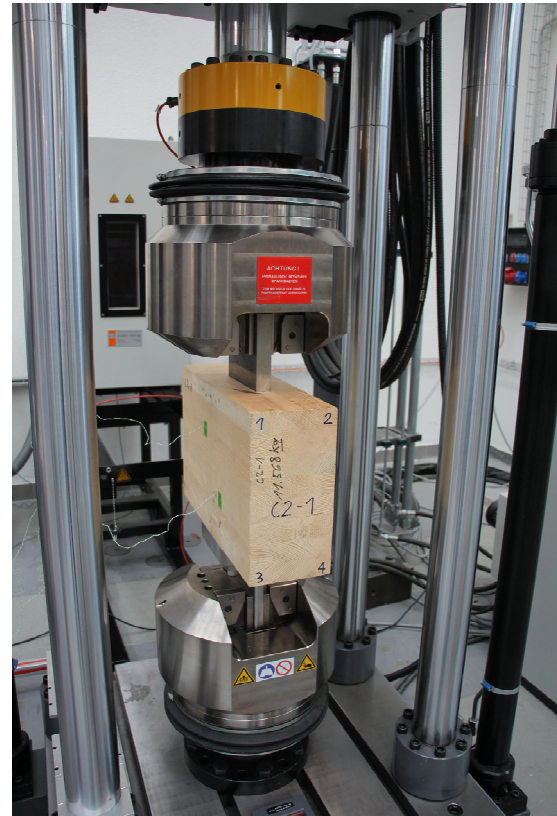
Abb. 3.28: 500 kN Ermüdungsprüfmaschine Walter & Bai LFV-500 der Empa in Dübendorf mit eingebauten Fichten-BSH-Prüfkörper (eingeklebte Gewindestangen rechtwinklig zur Faserrichtung).
