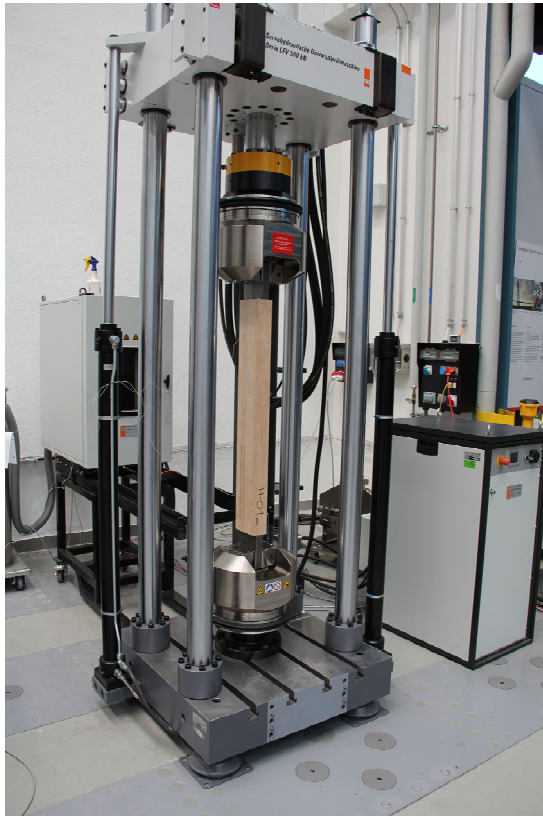
Abb. 3.27: 500 kN Ermüdungsprüfmaschine Walter & Bai LFV-500 der Empa in Dübendorf mit eingebauten Eschen-BSH-Prüfkörper (eingeklebte Gewindestangen parallel zur Faserrichtung).
