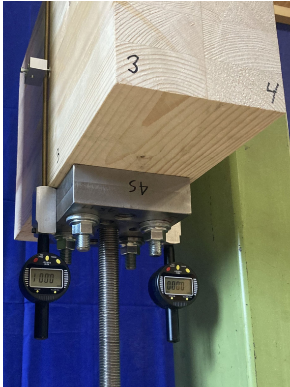
Abb. 3.23: Stahlteil und Verschiebungsmessungen am unteren Anschluss beim Prüfkörper B-1
