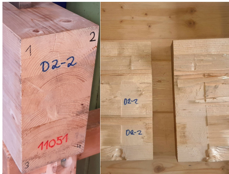
Abb. 3.38: Prüfkörper D2-02 nach allen Versuchen und Schnittflächen der Kreissäge in den aufgespaltenen Bruchflächen.
