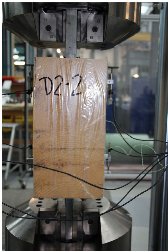
Abb. 3.34: Mit Kunststoff-Klebeband abgedeckte Stirnflächen der Fichten-BSH-Prüfkörper der Versuchsgruppe D – Beispiel: Prüfkörper D2-02.
