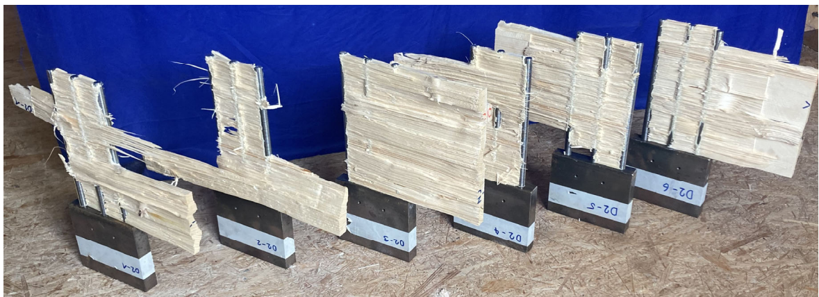
Abb. 4.49: Zerlegte Prüfkörper der Versuchsreihe D2: a) Rollschub-Bruchfläche und Klebfugen im Seitenteil des Prüfkörpers D2-01, b) Zusammenstellung aller Innenteile der Prüfreihe D2.
