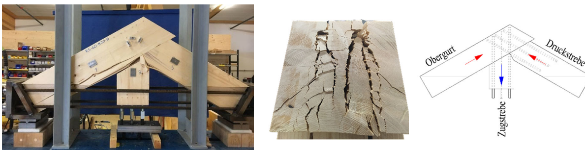
Abb. 1.1: Versuch im Labor der neuen Holzbau AG an einem Fachwerkknoten mit eingeklebten Gewindestangen. Der Prüfkörper zeigt das typische Versagen der zwischen den Ankerreihen liegenden, auf Rollschub beanspruchten Holzschicht. (Bilder: neue Holzbau AG).
