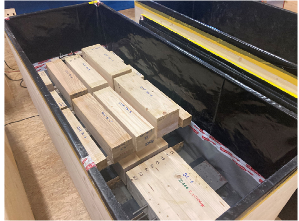
Abb. 3.12: Prüfkörper (Reihen D1 und D2) und Kontrollstäbe in der Klimakiste.
