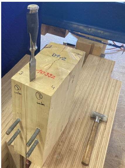
Abb. 3.37: Prüfkörper D1-02 mit ausgeprägten Rissen, die sich weiter aufspalten liessen.
