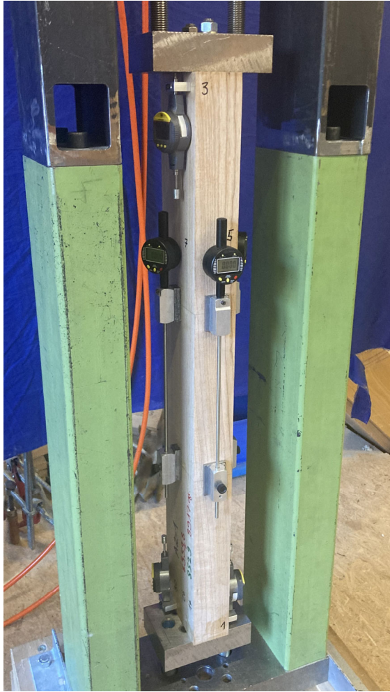
Abb. 3.21: Verschiebungsmessungen an einem Prüfkörper der Reihe A2.
