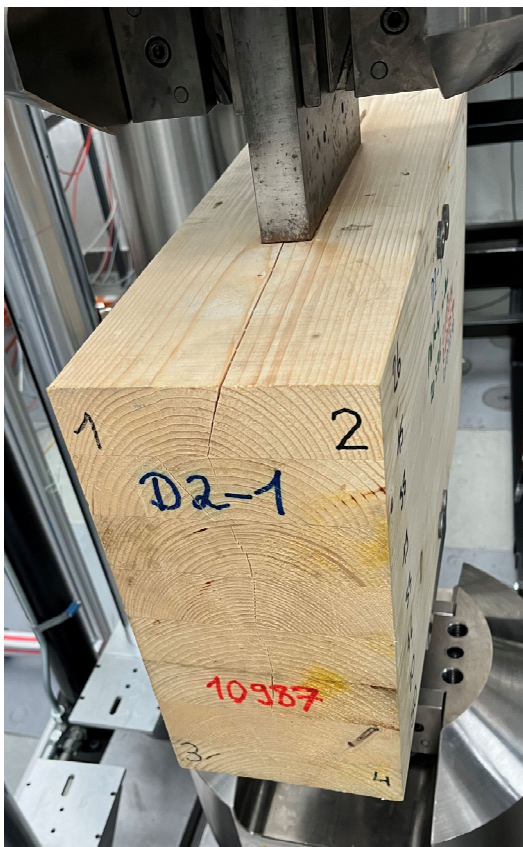
Abb. 3.33: Rissbildung beim Prüfkörper D2-01 nach 135'000 Lastwechseln im Ermüdungsversuch.
