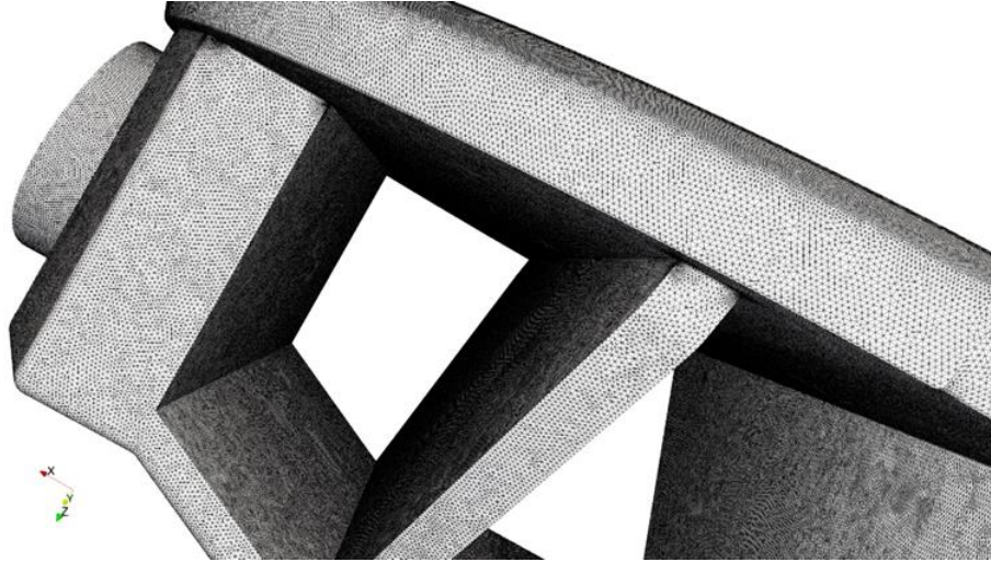
Figure 34 : Maillage "Moyen" sur le corps de vanne.
