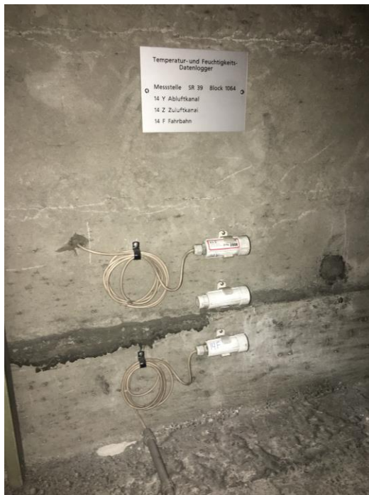
Abb. 18 Quelle links: Temperatur- und Feuchtigkeitsdatenlogger Gotthard-Strassentunnel 2018 (EBP Schweiz AG), Quelle rechts: Auswertung Messung Temperatur (rot) und Luftfeuchtigkeit (blau) im Gotthard-Strassentunnel, Tagesverlauf eines durchgezogenen Tages (12.09.2011) (EBP Schweiz AG)
