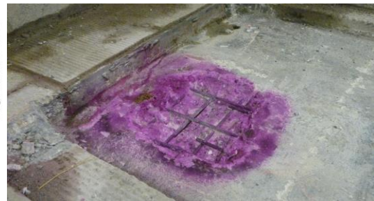
Abb. 9 Quelle links: SIA 262.495 / SN EN 14630, Bild 1 – Karbonatisierungsgrenze, Quelle rechts: Fahrbahnplatte Gubristtunnel 2013 (EBP Schweiz AG)
