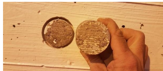
Abb. 11 Quelle links: SIA 281/3, Figur 1, Schnitt durch den aufgeklebten Zugkörper mit durchtrennter Abdichtung, Quelle rechts: Haftzugprüfung OS Wand Tagbau Gubristunnel 2019 (EBP Schweiz AG)
