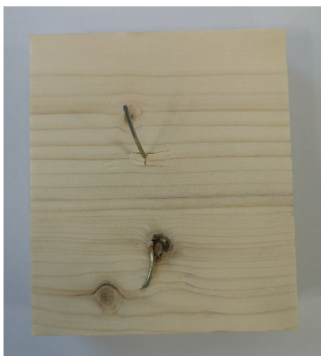
Abbildung 2-25: Abbildung einer eingeschossenen Klammer auf der Rückseite der Dreischichtplatte. Ein Drahtteil drang mit einer breiten Spreizung in das Vollholz, der andere Draht hatte eine solch starke Spreizung, dass er sich über 90° krümmte und nie im Vollholz ankam.
