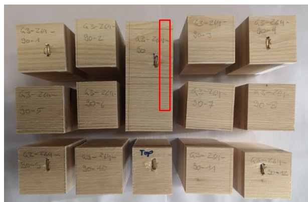
Abbildung 3-11: Die rote Markierung zeigt die Stelle, an der die Proben für die Mikroskopie entnommen wurden
