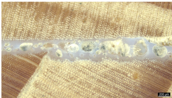
Abbildung 3-50: Mikroskopie Bild der Verklebung G3-Q63-90 mit grosser Oberflächenrauheit der Dreischichtplatte.
