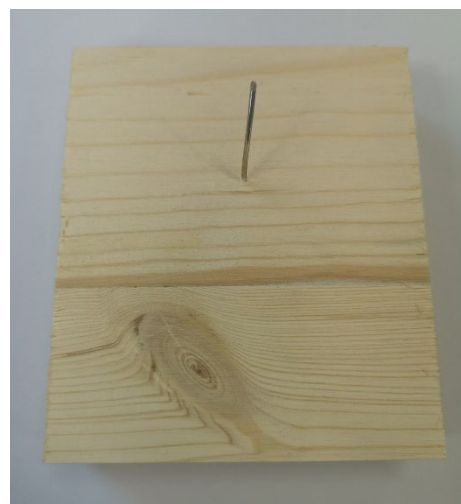
Abbildung 2-26: Abbildung einer eingeschossenen Klammer auf der Rückseite der Dreischichtplatte. Ein Drahtteil drang mit einer breiten Spreizung in das Vollholz. Der Verlauf des anderen Drahtende ist unbekannt. Eventuell gibt es einen Einfluss des Verlaufs auf Grund des Astes in der Decklage.
