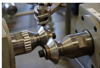
Abbildung 11. Die Versuche wurden am Institut für Werkstoffsystemtechnik Thurgau (WITg) auf einer Twin-Disk Anlage mit einem Druck von 1 GPa, einer Geschwindigkeit von 1,00 m/s auf der Radseite (Radstahl ER7 grade, Lucchini SR) und 0,99 m/s auf der Schienenseite (Schienenstahl R260, Voestalpine) (SRR = 1%) durchgeführt.
