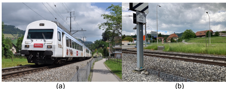
Abbildung 18. (a) Kambly-Zug von BLS mit installierten Sprühdüsen für Konditioniermittel und (b) Position, an der die Proben vom Schienenkopf entnommen wurden (geographische Koordinaten: N 46.898, E 7.4015).
