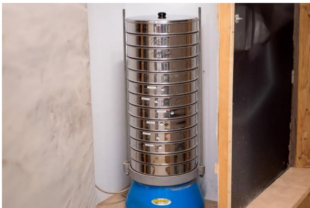
Abbildung 3: Siebturm zur Trockensiebung, Quelle: innovativbeton-muenchen
