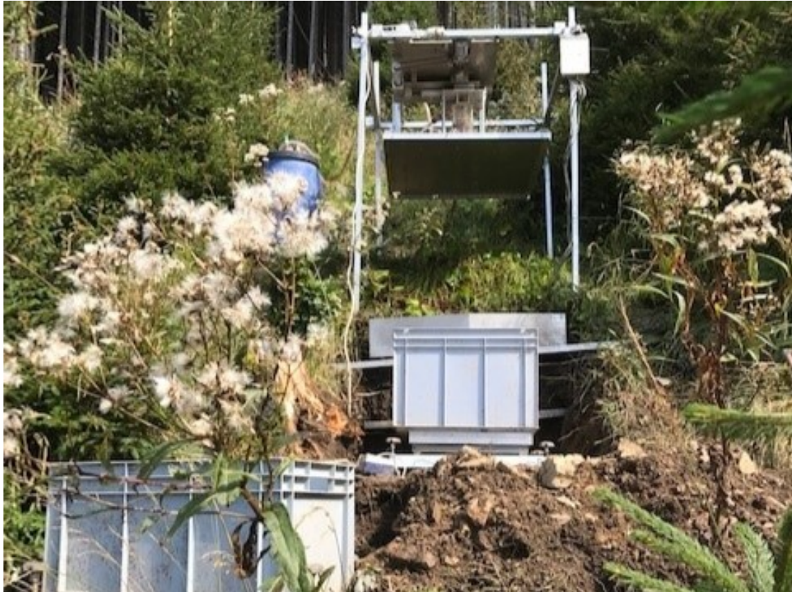
Abbildung 2: Beispiel für den Regensimulator auf Profilskala im Einsatz auf der Schlagfläche in der Gemeinde Eschen.
