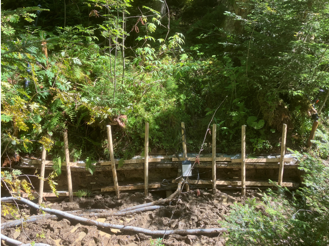
Abbildung 12: Beispiel für den Regensimulator auf Böschungsskala im Einsatz auf der Tannenfläche in der Gemeinde Rüschegg.
