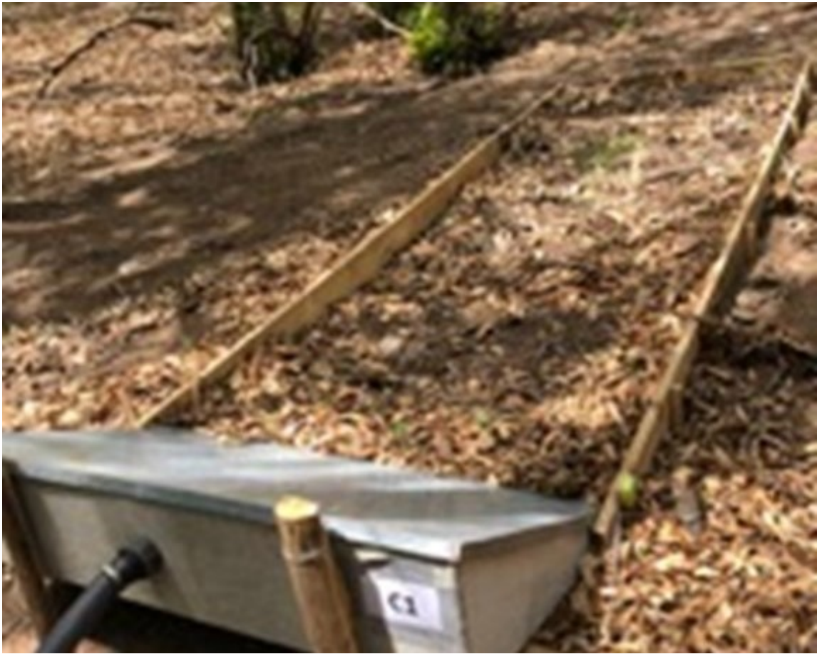
Abbildung 15: Beispiel für ein Kastenerosimeter für die Überwachung der Dynamik auf der Bestandesfläche im Bezirk Lugano.
