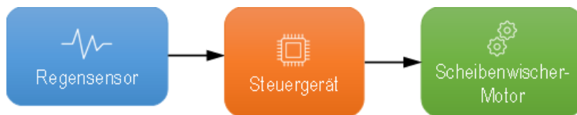
Abbildung 65: Blockschaltbild Regensensor (VS28)
