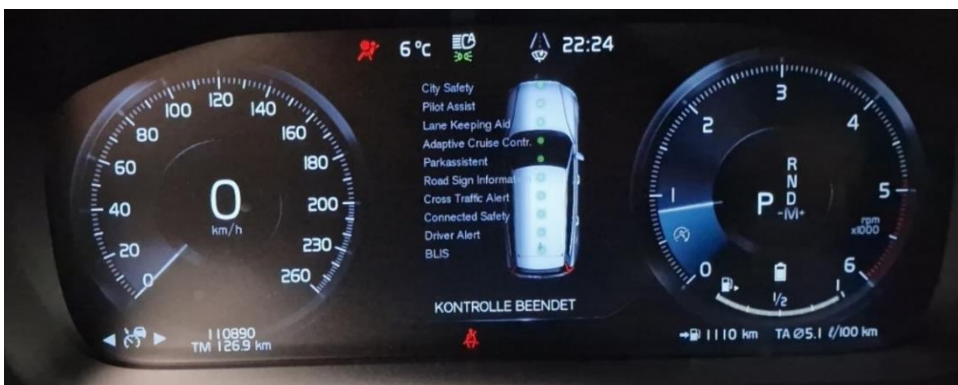
Abbildung 3: Kombiinstrument MJ2021 Volvo V60 B4, Endphase der Lampenprüfung der Kontrollleuchten mit Statusanzeige der FAS
