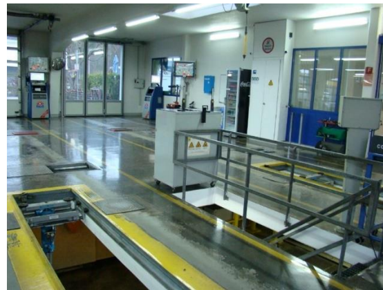
Abbildung 70: Prüfbahn mit Grube
