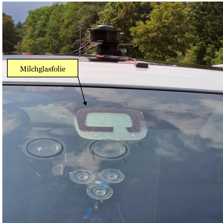
Abbildung 10: Störung der Kamerafunktion durch das Anbringen von Milchglasfolie auf der Frontscheibe
