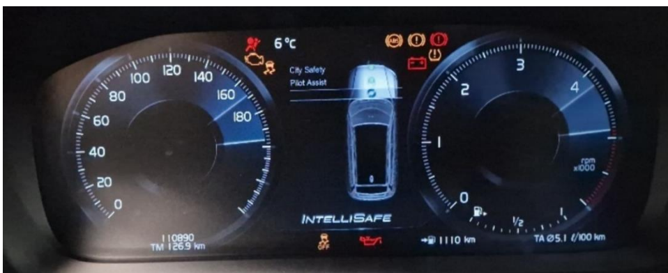
Abbildung 2: Kombiinstrument MJ2021 Volvo V60 B4, Anfangsphase der Lampenprüfung der Kontrollleuchten
