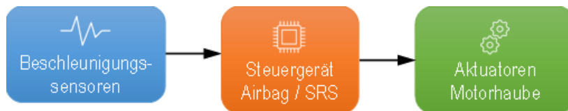
Abbildung 64: Blockschaltbild aktive Motorhaube (VS26)
