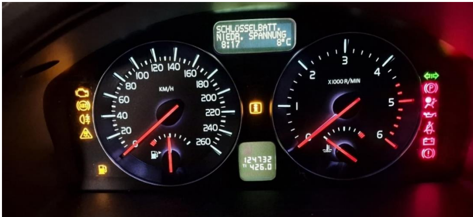
Abbildung 1: Kombiinstrument MJ2012 Volvo V50 D3, Anzeigedauer der Lampenprüfung der Kontrollleuchten ca. 2 Sekunden
