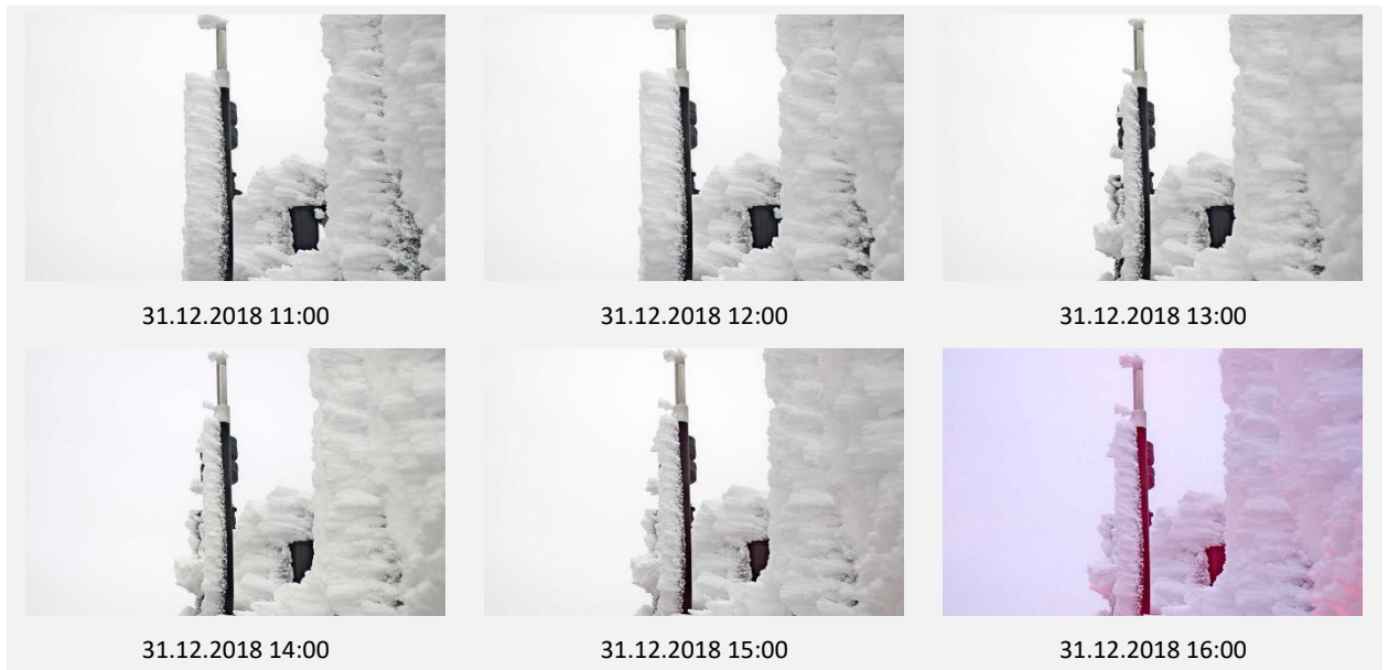
Abbildung 9: Vereisungsereignis am 31.12.2018 in Ostkanada. Die Bilder zeigen den Verlauf des Vereisungsereignisses. Die meteorologischen Bedingungen sind in der Zeitreihe in Abbildung 10 dargestellt.
