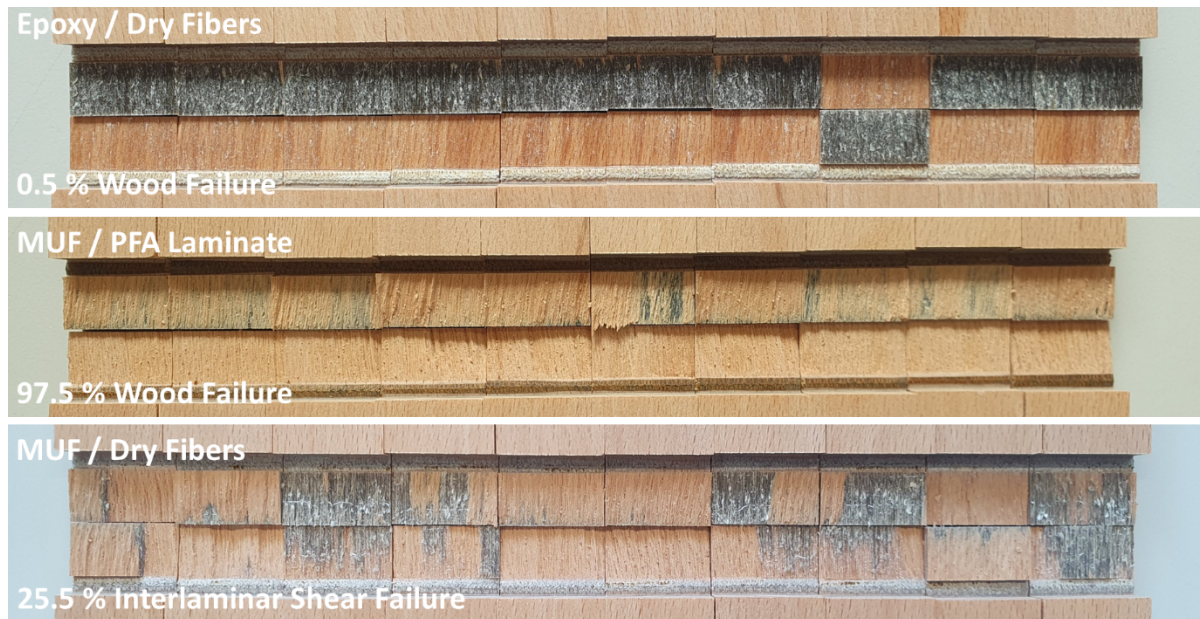
Abbildung 14: Ausgewählte Prüfkörper nach dem Zugscherversuch mit typischem Adhäsionsversagen (oben), hohem Holzbruchanteil (mittig) und einer Mischung aus Holzbruch und interlaminarem Schubversagen (unten)
