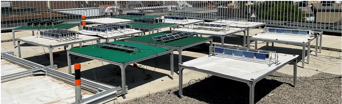
Abbildung 4: Miniaturisierte Testsysteme, die die Realisierung verschiedener PV-Systeme und einen direkten Vergleich der Energieerträge erlauben.
