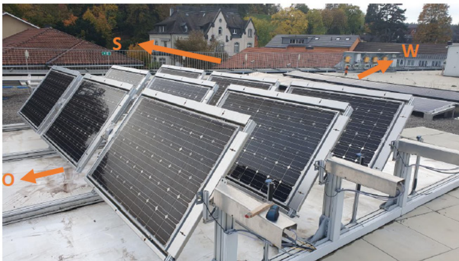
Abbildung 3: BIFOROT mit sich kontinuierlich drehenden bifazialen Modulen, wobei ein Zyklus innerhalb von zwei Minuten durchlaufen wird. Gemessen wird das mittlere Modul der mittleren Reihe.
