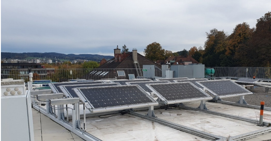
Abbildung 40: BIFOROT (Bifacial Outdoor Rotor Tester) auf dem Dachlabor
