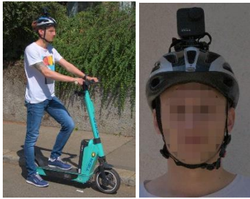
Abb. 43 Teilnehmender mit instrumentiertem E-Trottinett und Kamera auf dem Helm.
