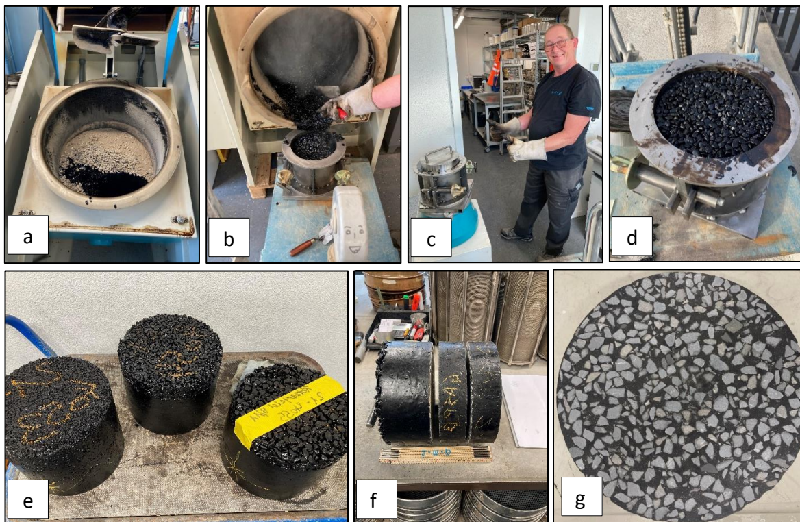
Abbildung 5: Probenvorbereitung nach der Mastix-Methode: a) Mischungsvorbereitung, b) Füllen der Form, c) Vibration, um eventuelle Luftblasen zu entfernen, d) gefüllte Form, e) ausgeschaltete Proben, f) geschnittene Proben, g) Ansicht von oben.
