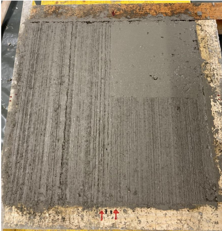
Abbildung 43: Beispiel einer Betonplatte (48 x 48 x 10) cm mit verschiedenen Oberflächen-Bearbeitungen (oben rechts: keine Textur / unten rechts Strohbesen / links Strassenbesen).
