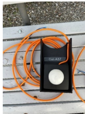
In Ringoldingen wurden DALI-Bewegungsmelder installiert. Die Einbindung der Bewegungsmelder erfolgt direkt auf den DALI-Bus (Prinzipschema Bild links). Auf dem Foto rechts ist der Bewegungsmelder zusammen mit Kabeln und einer Schutzhaube zu sehen, die für den Witterungsschutz sorgt. Das Bild rechts zeigt die Montage des Bewegungsmelders am Kandelaber. Da der DALI-Bewegungsmelder nicht für den Einsatz im nassen Außenbereich vorgesehen ist, wurde die Schutzhaube speziell für dieses Einsatzgebiet von der BLS angefertigt.
