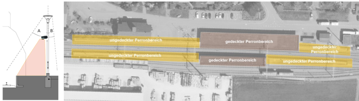
Das linke Bild zeigt den Kandelaber mit dem installierten Bewegungsmelder sowie den rot markierten Erfassungsbereich. Das rechte Bild stellt den Bahnhof Müntschmied dar, wobei die überdachten Perronbereiche in Braun-Rot und die ungedeckten Perronbereiche in Gelb gekennzeichnet sind. Die präsenzgesteuerte Perronbeleuchtung kommt im unbedeckten Perronbereich zum Einsatz
