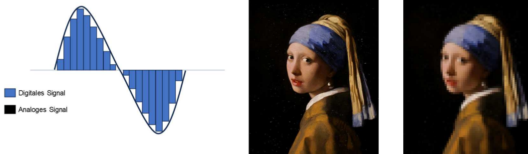
Abb. 19 Illustration des Informationsverlusts bei der Umwandlung von analog zu digital
