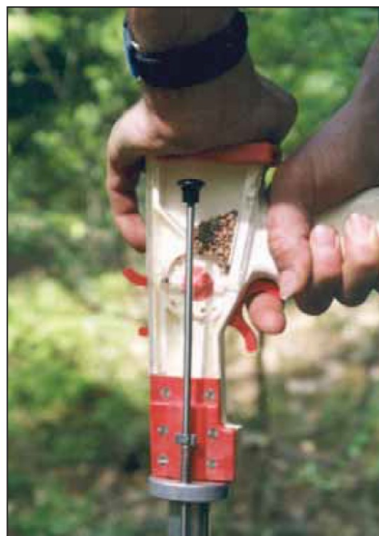
Eine Transportscheibe nimmt eine bestimmte Anzahl Samenkörner mit. Meist fielen zwei bis drei Körner in den Kegel.
