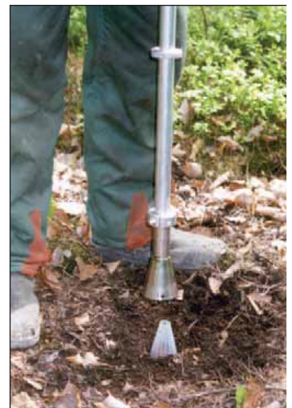
Mit dem schwarzen Hebel neben dem Samendepot (Abb. 5) wird der Plastikkegel freigegeben.
