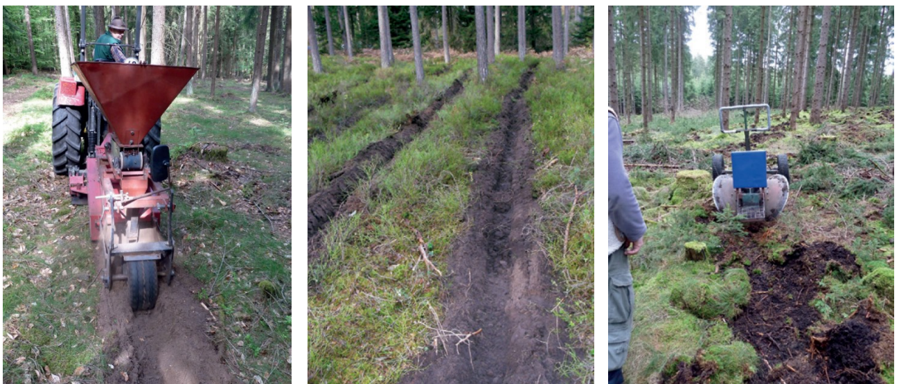
Abbildung 4 Links: eine Rotbuchensaat mit langsam laufender Fräse und Saatgerät. Mitte: Rillensaat für Eiche mit Fräse. Rechts: Anlage von Saatrillen für Weisstanne mit Scheibenegge (Ruppert & Rothkegel 2018)
