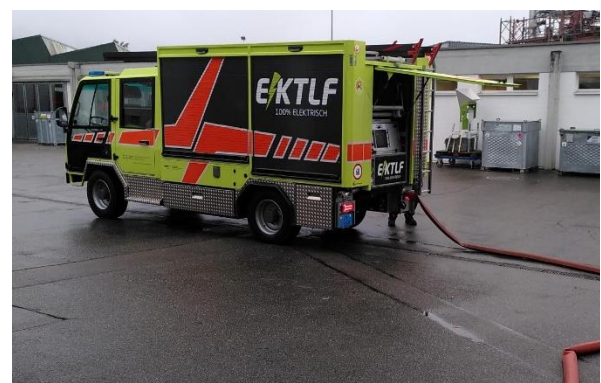
Abbildung 39: Nachtanken des EEF am Hydrant nach absolvierten Lärmmessungen der Löschpumpe
