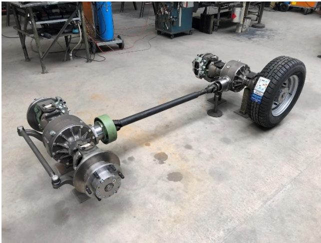
Abbildung 14: Beispiel eigengefertigter Standard- Antriebsachsen und -systeme mit Kardanwelle, Planetengetriebe und Tellerrad
