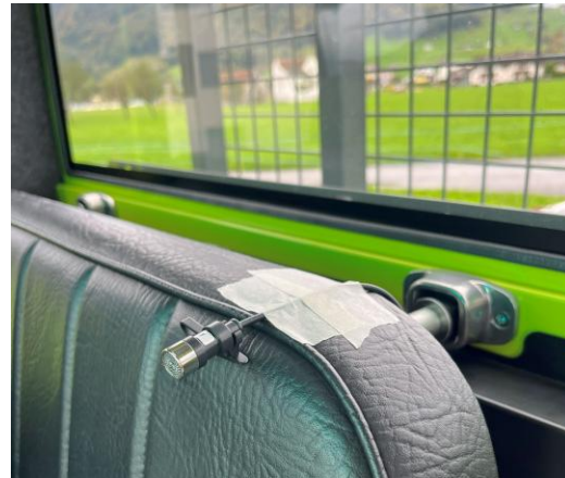
Abbildung 37: Messung der Lärmimmission in der Kabine.
