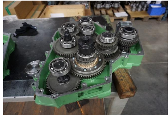
Abbildung 18: Einblick in das Gehäuse bzw. die Montage des Stirnrad-Getriebe für den elektrischen Fahrtrieb
