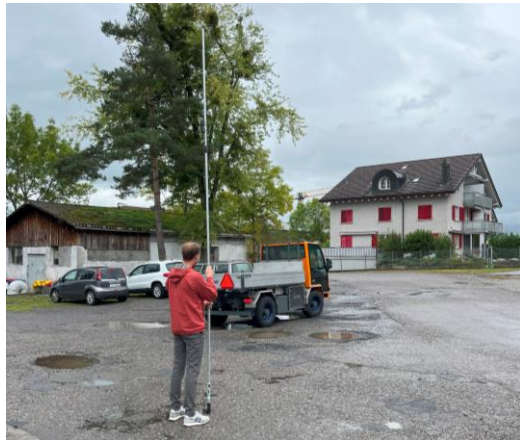
Abbildung 36: Messung der Lärmimmission im auf Halbsphäre.
