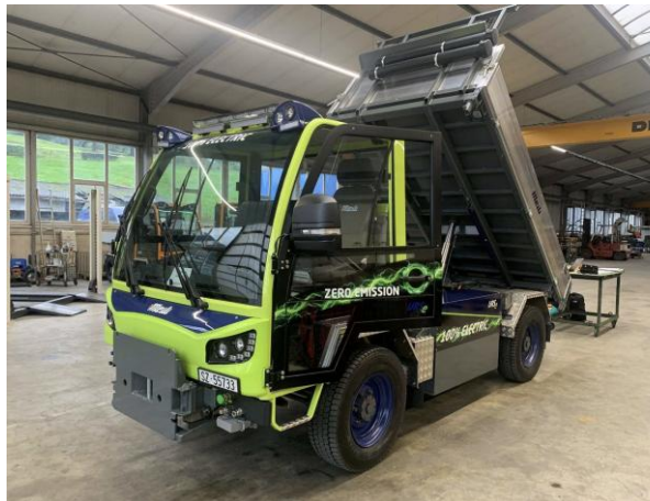
Abbildung 57: Frontansicht des URS.e Kommunalfahrzeugs mit Ladefläche
