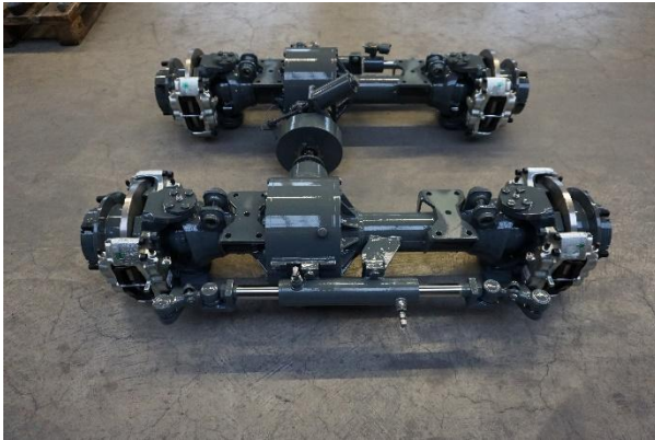
Abbildung 17: Eigengefertigte, neue Antriebsachsen und -systeme mit optimierten Getriebestufen für elektrische Motoren
