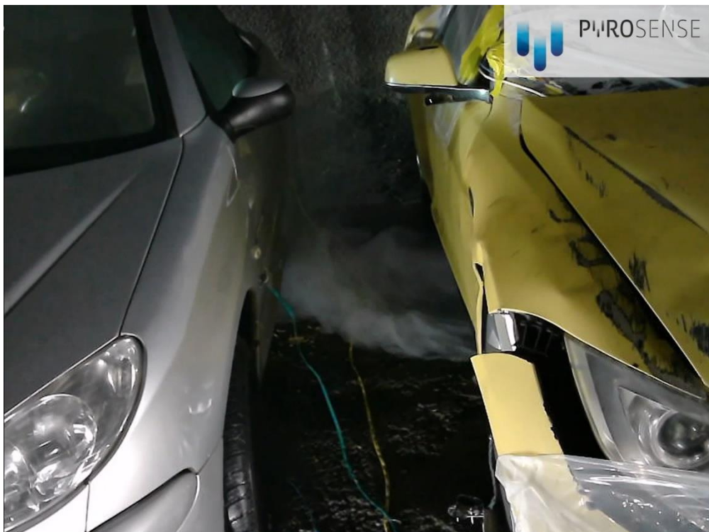
Abbildung 1: 14:56 Uhr, Rauch entweicht aus den Ventilen unter dem Tesla, Foto zwischen den Autos
