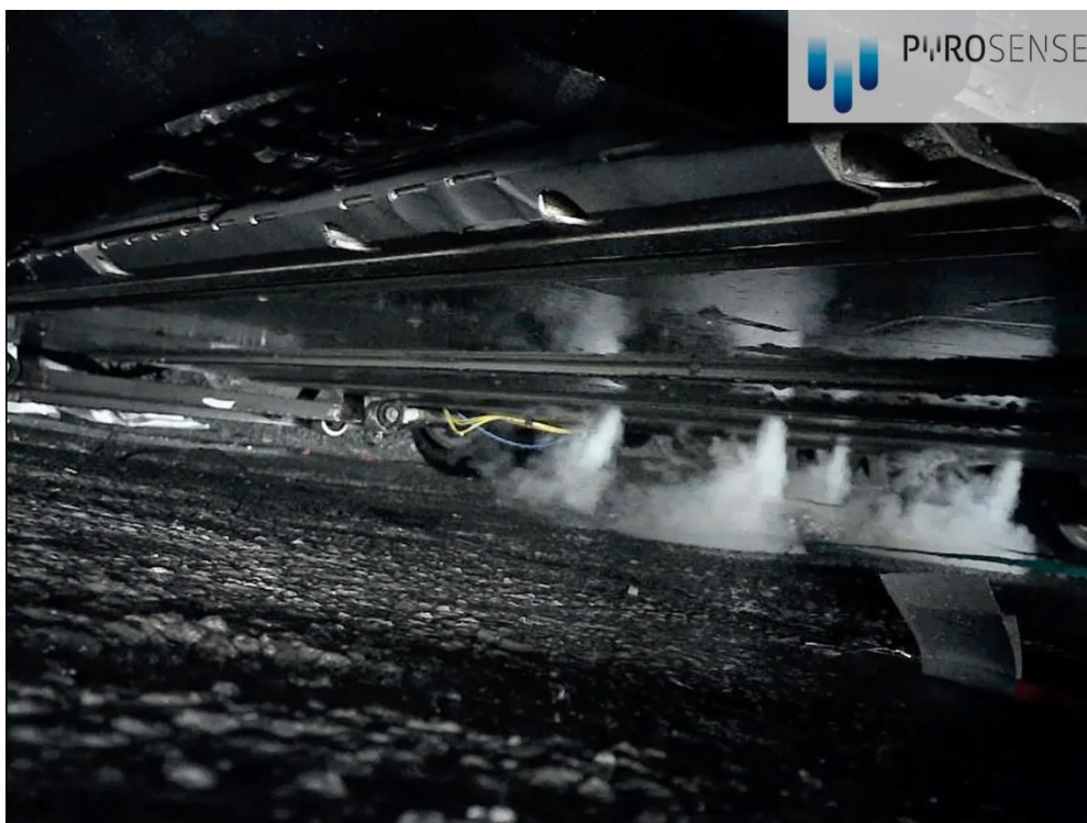
Abbildung 2: 14:56 Uhr, Rauch entweicht aus den Ventilen unter dem Tesla, Foto unter dem Tesla
