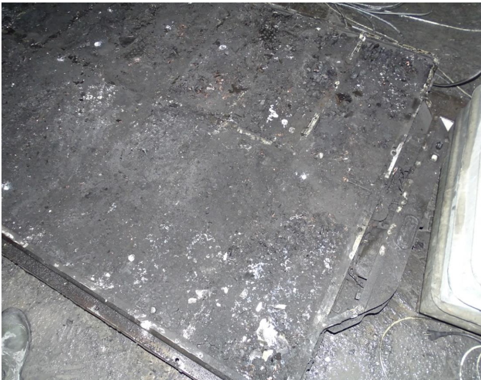
Abbildung 10: Beim Recycling der Batterie wurde festgestellt, dass sich der Thermal Runaway auf alle Module ausgebreitet hatte.
