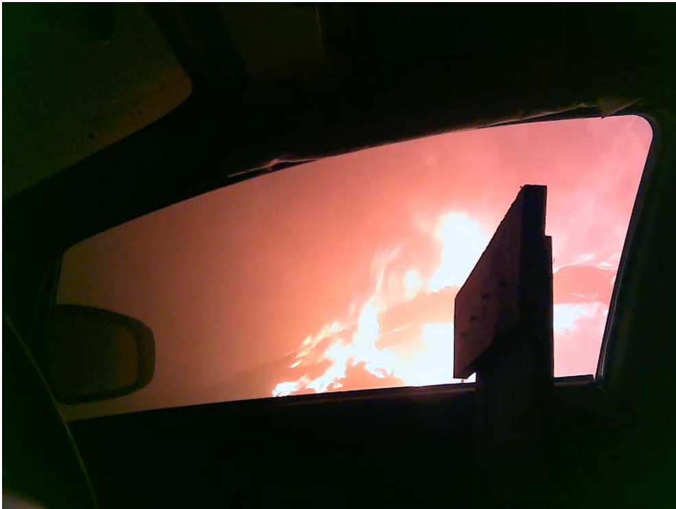
Abbildung 5: 16:52 Uhr, Durch die Hitze im Inneren des Fahrgastraums schmilzt das Polykarbonatdach des Tesla. Weitere Knalle (Kamera im E-Auto links)
