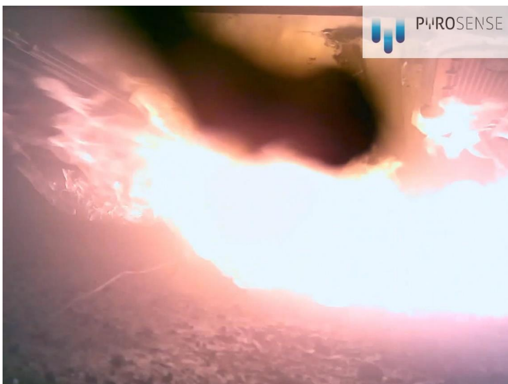
Abbildung 4: 14:37 Uhr, Flammen aus den Überdruckventilen im Autoboden
