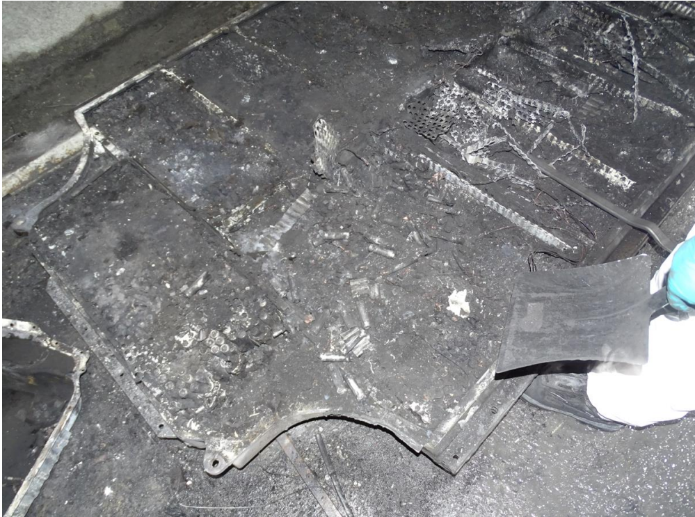
Abbildung 9: Beim Recycling der Batterie wurde festgestellt, dass sich der Thermal Runaway auf alle Module ausgebreitet hatte.
