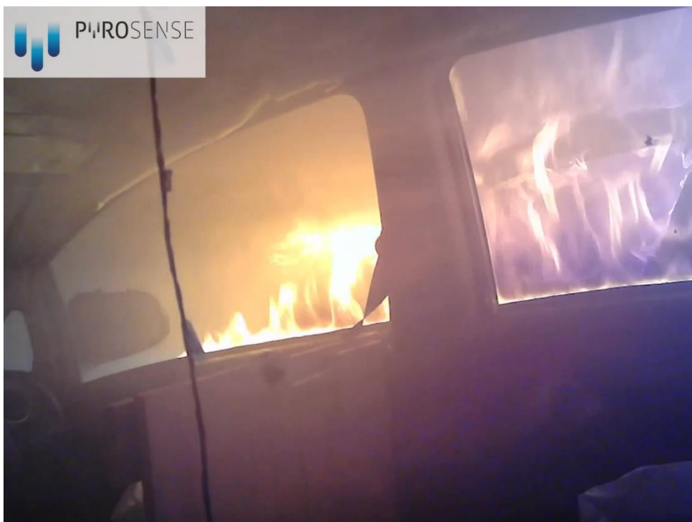
Abbildung 6: 15:05 Uhr, Ohne Sprinkler nimmt die Intensität des Feuers stark zu. Brandüberschlag auf das seitliche E-Auto: Der Lack der Autotüren fängt Feuer.
