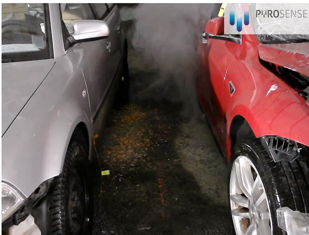
Abbildung 1: 13:46 Uhr, Rauch entweicht aus den Ventilen unter dem Tesla, Foto zwischen den Autos
