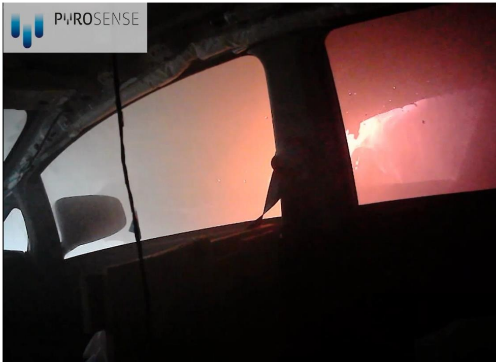
Abbildung 5: 14:45 Uhr, Die Sprinkleranlage bringt das Feuer unter Kontrolle. Der Brand beschränkt sich nur auf den Fahrgastraum des Tesla
