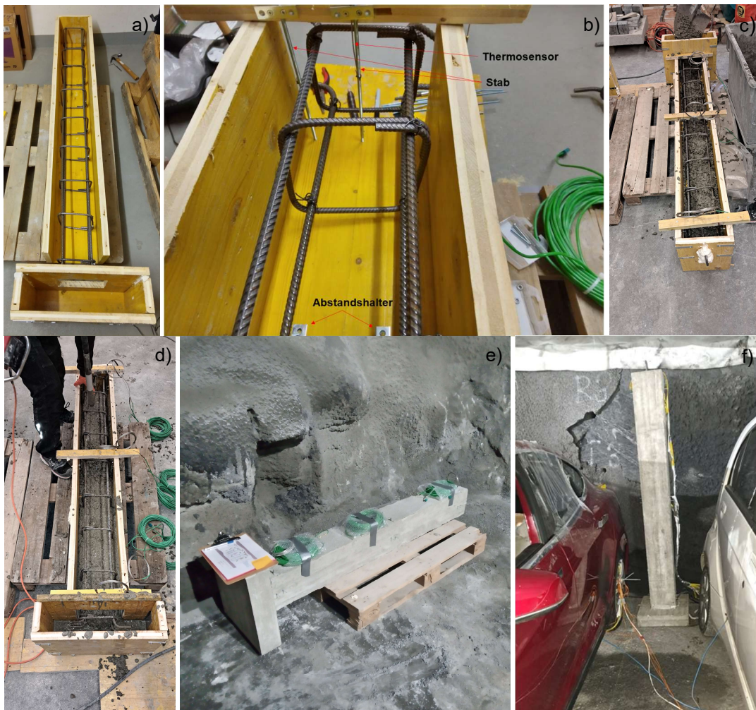
Abbildung 6. Herstellung der Schalung (a), Montierung der Bewehrung und der Sensoren (b), Betonierung (c), Vibrieren (d), Lagerung (e) und Positionierung zwischen E-Autos (f)
