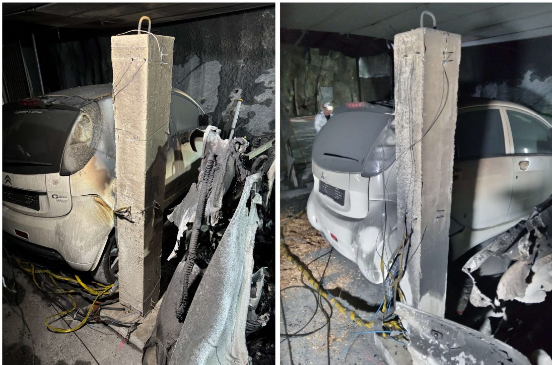
Abbildung 7. Zustand der Stützen nach den Brandversuchen: mit Sprinkler (links) und mit FASR (rechts)
